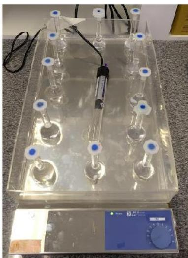
Figura 10. Ensaio de liberação da DUTA.
