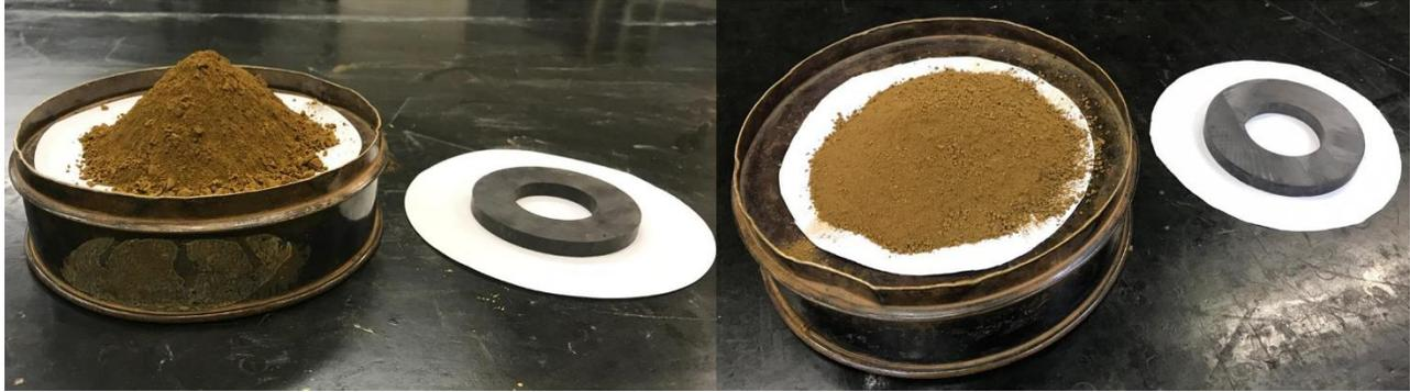
Figura 4.14 – Ensaio de avaliação do comportamento magnético.
