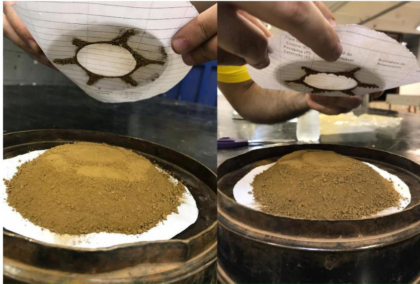
Figura 5.27 – Ensaio de potencial metálico do solo tropical.
