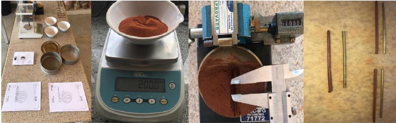
Figura 4.13 – Equipamentos de Casagrande para ensaios de limite de liquidez e limite de plasticidade respectivamente e detalhes da realização do ensaio.
