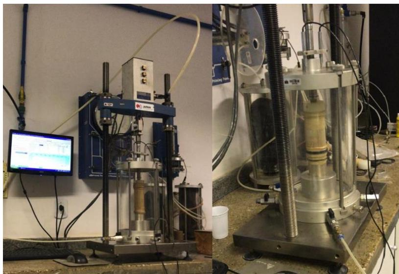
Figura 4.16 – Ensaio de Módulo de Resiliência.
