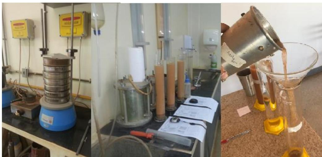
Figura 4.12 – Ensaio de granulometria por peneiramento e sedimentação (com e sem defloculante).
