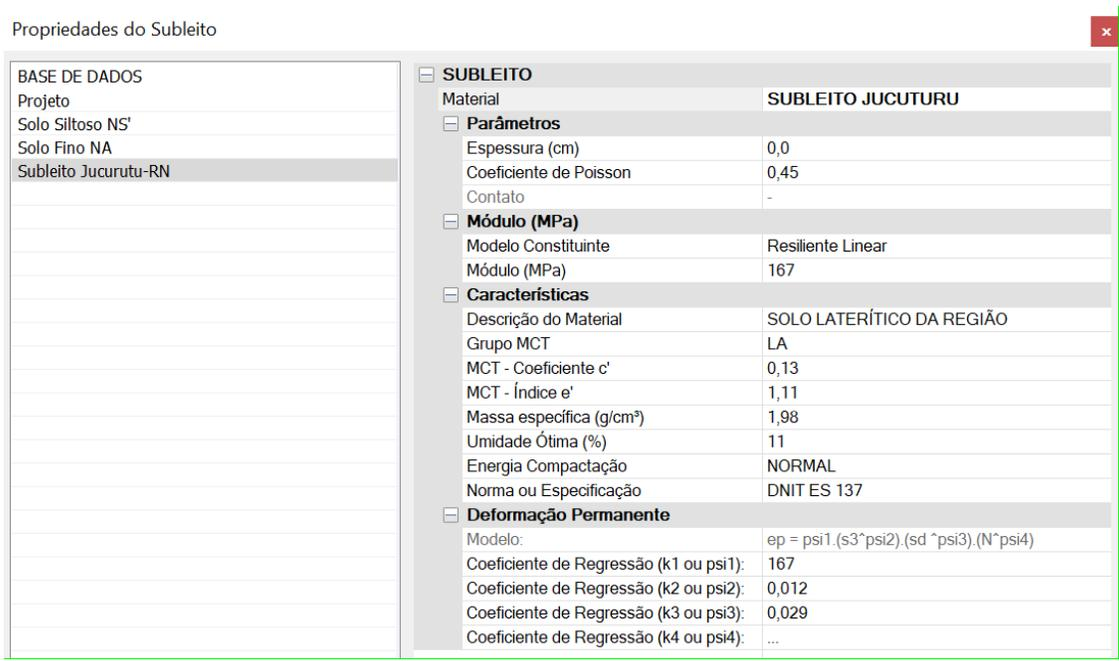
Figura 5.66 – Dados do subleito para o pavimento flexível utilizando apenas o solo natural.
