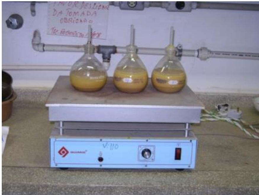
Figura 4.11 – Ensaio de massa específica dos sólidos.
