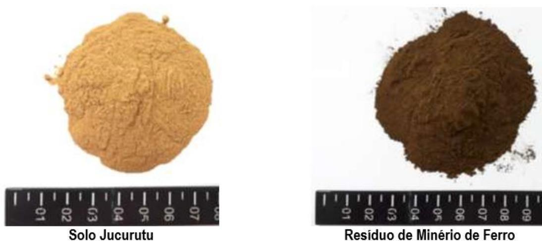
Figura 4.9 – Amostras analisadas nos ensaios FRX.
