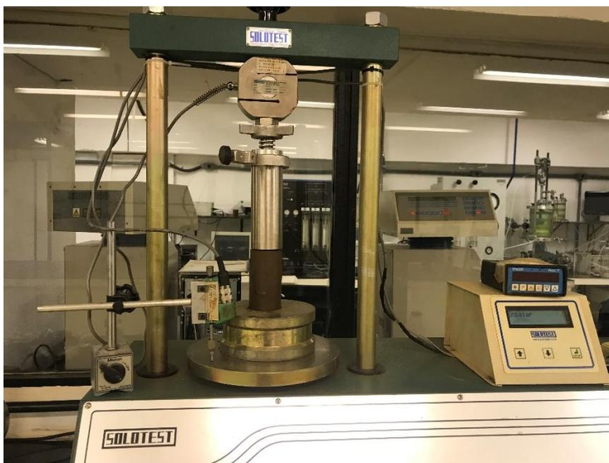
Figura 4.15 – Ensaio de Resistência à Compressão Simples.
