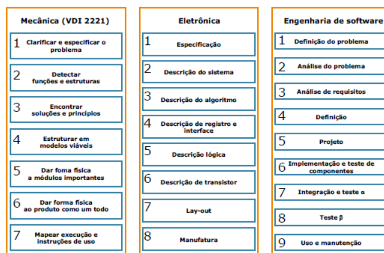
Figura 17 – Fluxo principal de atividade de projeto mecânico, eletrônico e de software . Fonte: Bernardi et al. (2002).
