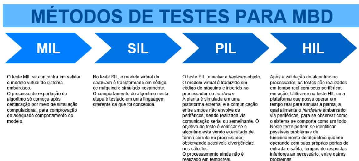
Figura 22 – Sequência de técnicas para verificação de modelos Fonte Própria.
