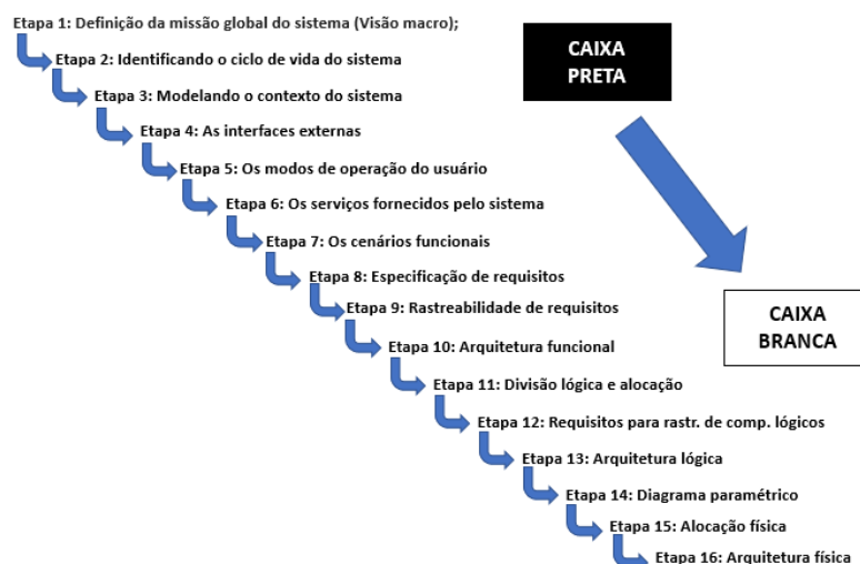
Figura 13 – Abordagem Top-down . Fonte Própria.
