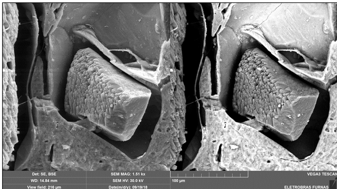
Figura 4.75. Grão de quartzo envolto por uma espécie de capa em meio a matriz ferruginosa do nódulo. À esquerda, Imagem MEV; à direita imagem formada por “backscattering electron”- BSE (retroespalhamento de elétrons), demonstrando o contraste de peso entre os minerais
