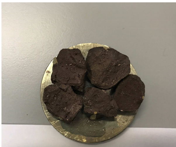
Figura 3.9. Amostra UEG-Anápolis fixada no porta amostras e em seguida metalizada para uso da técnica de alto vácuo.
