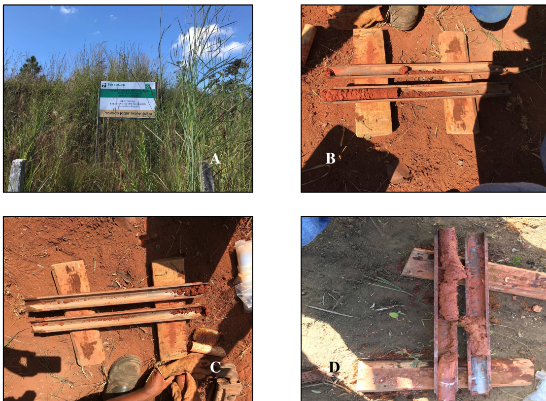
Figura 3.2. Localização e amostragem dos perfis Lago Sul 1 e 2 por meio de sondagem SPT. A) Placa de Identificação do Parque Bernardo Sayão; B), C) recuperação de solo pelo amostrador SPT; D) recuperação de solo pelo amostrador SPT no perfil Lago Sul 1 a aproximadamente 4m de profundidade, com aparecimento do NA.
