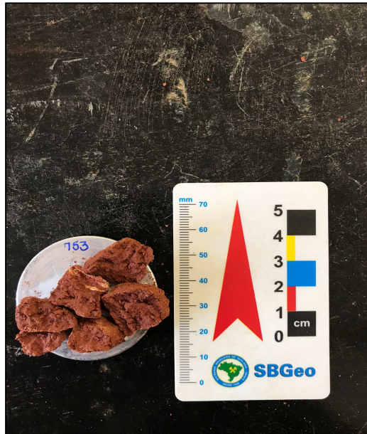
Figura 3.7. Fixação das amostras de torrões de solo no porta-amostras por meio de cola.
