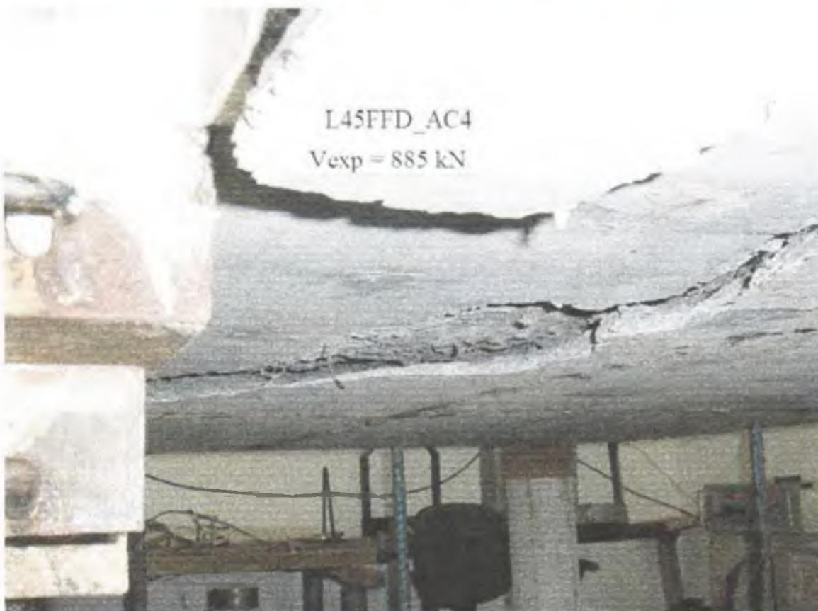
Figura 5.41 – Fotografias das superfícies de ruptura das lajes da Série 3 (continuação)
