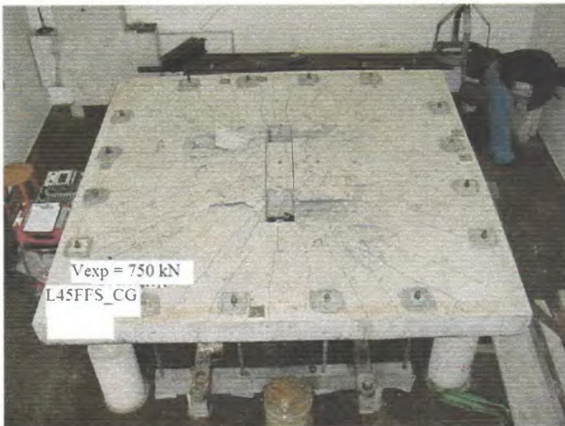
Figura 5.30 – Fissuração na laje L45FFS\_CG
