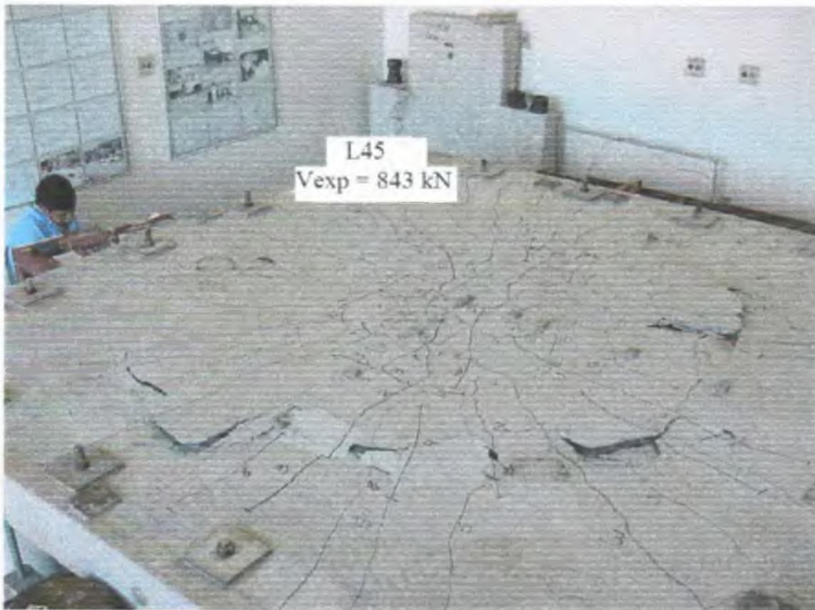
Figura 4.25 – Fissuração na laje L45
