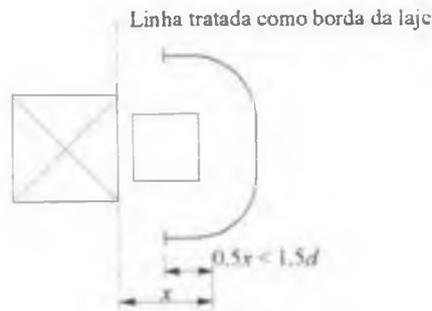
Figura 2.55 – Tratamento da laje PSSCH1 como laje com pilar de borda
