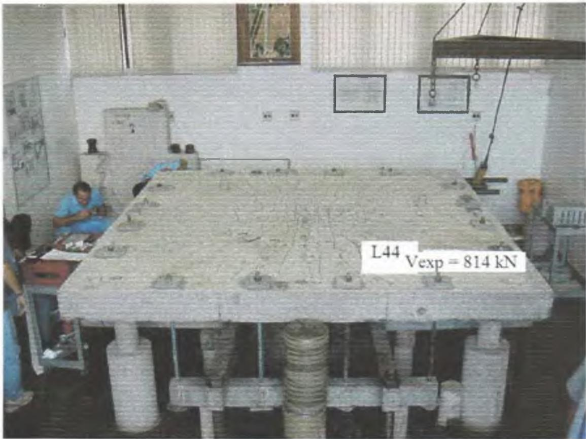
Figura 4.24 – Fissuração na laje L44
