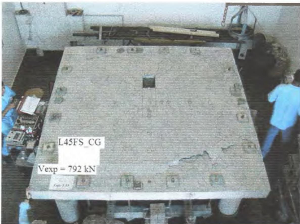
Figura 5.27 – Fissuração na laje L45FS\_CG
