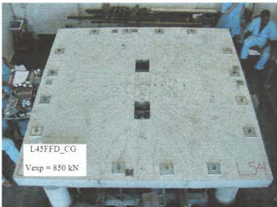
Figura 5.31 – Fissuração na laje L45FFD\_CG
