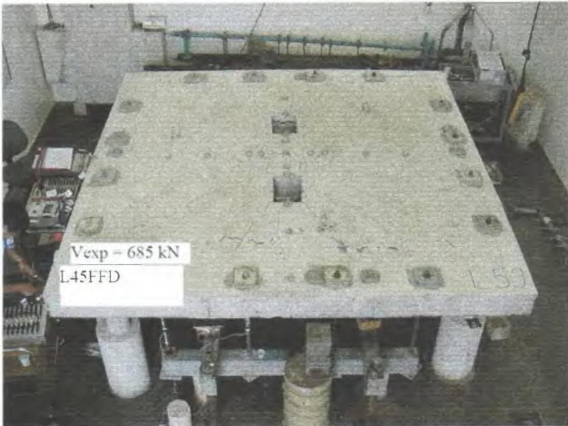
Figura 5.32 – Fissuração na laje L45FFD
