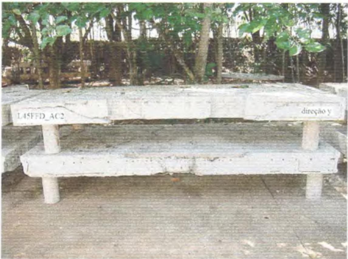
Figura 5.41 – Fotografias das superfícies de ruptura das lajes da Série 3
