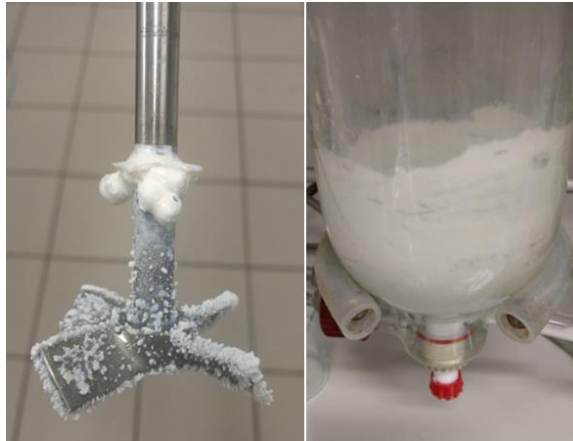
Figura 40: Imagem da âncora de agitação mostrando o depósito de coágulos.
