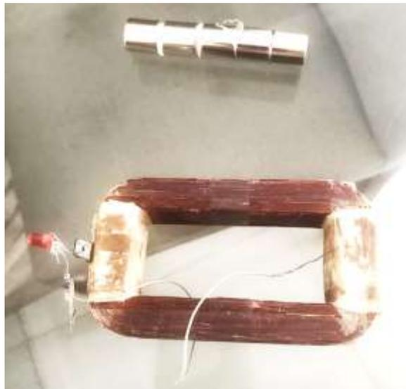
**Figura 7-** Uma bobina retangular e cinco ímãs de neodímio
