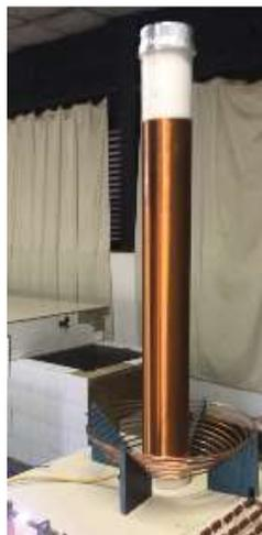
**Figura 15-** Bobinas primária e secundária
