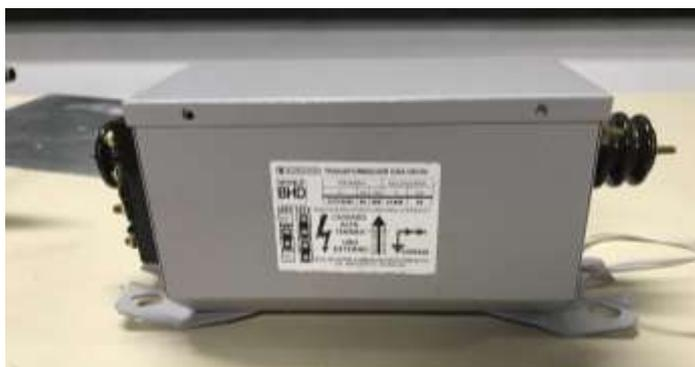
**Figura 12-** Transformador Gás neon de 12kV usado no artefato.
