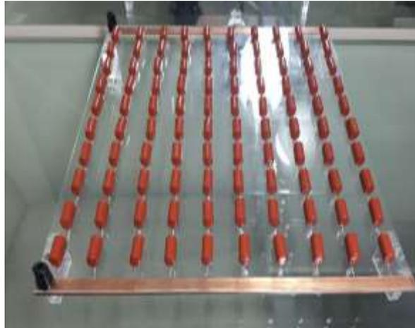
**Figura 13-** Banco de capacitores- total de 100 capacitores associados
