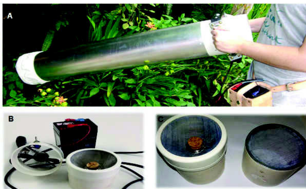
Figura 13 - Aspiradores elétricos de Nasci (Horst armadilhas). A: Aspirador elétrico grande; B: Aspirador elétrico pequeno desacoplado do copo/pote coletor; C: pote coletor com a tampa em funil invertido.
