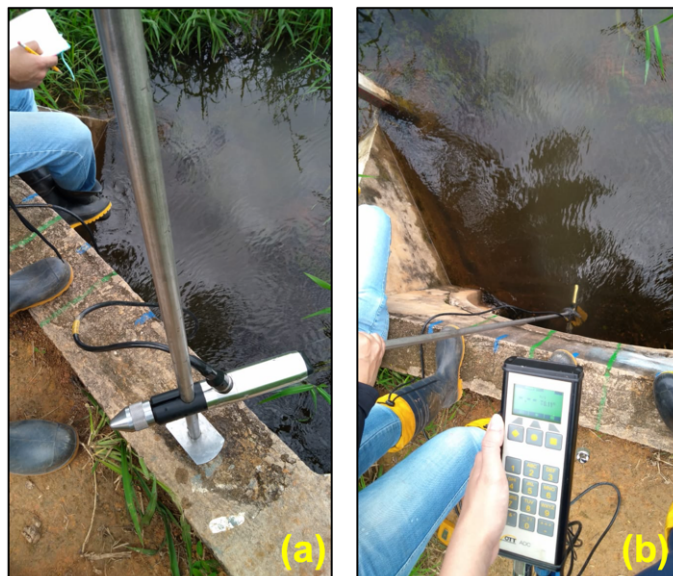
Figura 4.31 – (a) Sensor do ADC; (b) Utilização do ADC na saída da lagoa de detenção.
