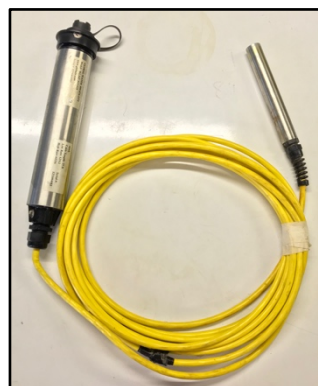
Figura 4.24 – Linígrafo de pressão, modelo WL16. Datalogger conectado ao transdutor de pressão por meio de cabo de 7,6 m.
