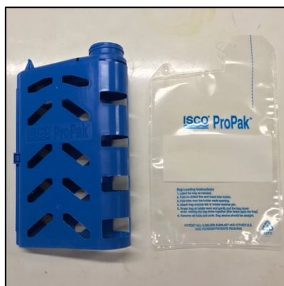
Figura 4.39 - Embalagem plástica de 1L de capacidade para acondicionar as amostras e suporte azul para encaixe no amostrador automático.
