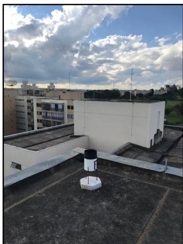
Figura 4.20 – Pluviógrafo no telhado de prédio em AOS 1, Octogonal.
