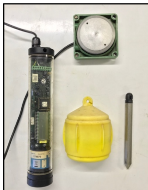
Figura 4.23 – Linígrafo de boia, modelo Thalimedes. Componentes: Datalogger associado à polia, boia e contrapeso.
