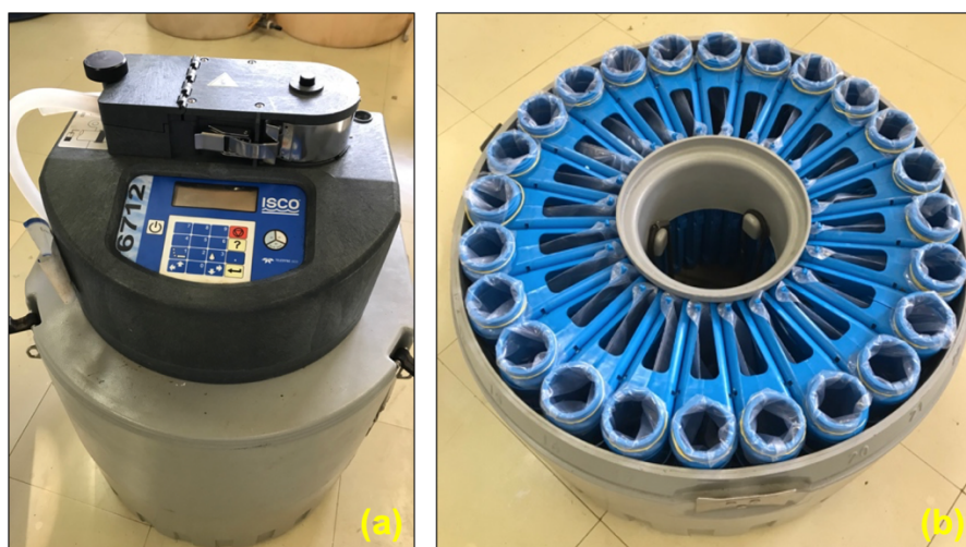
Figura 4.38 – (a) Amostrador automático ISCO 6712; (b) Parte inferior do amostrador automático, onde as amostras são armazenadas.
