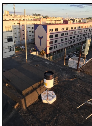
Figura 4.19 – Pluviógrafo no telhado do edifício no SHCES 409, Cruzeiro Novo.
