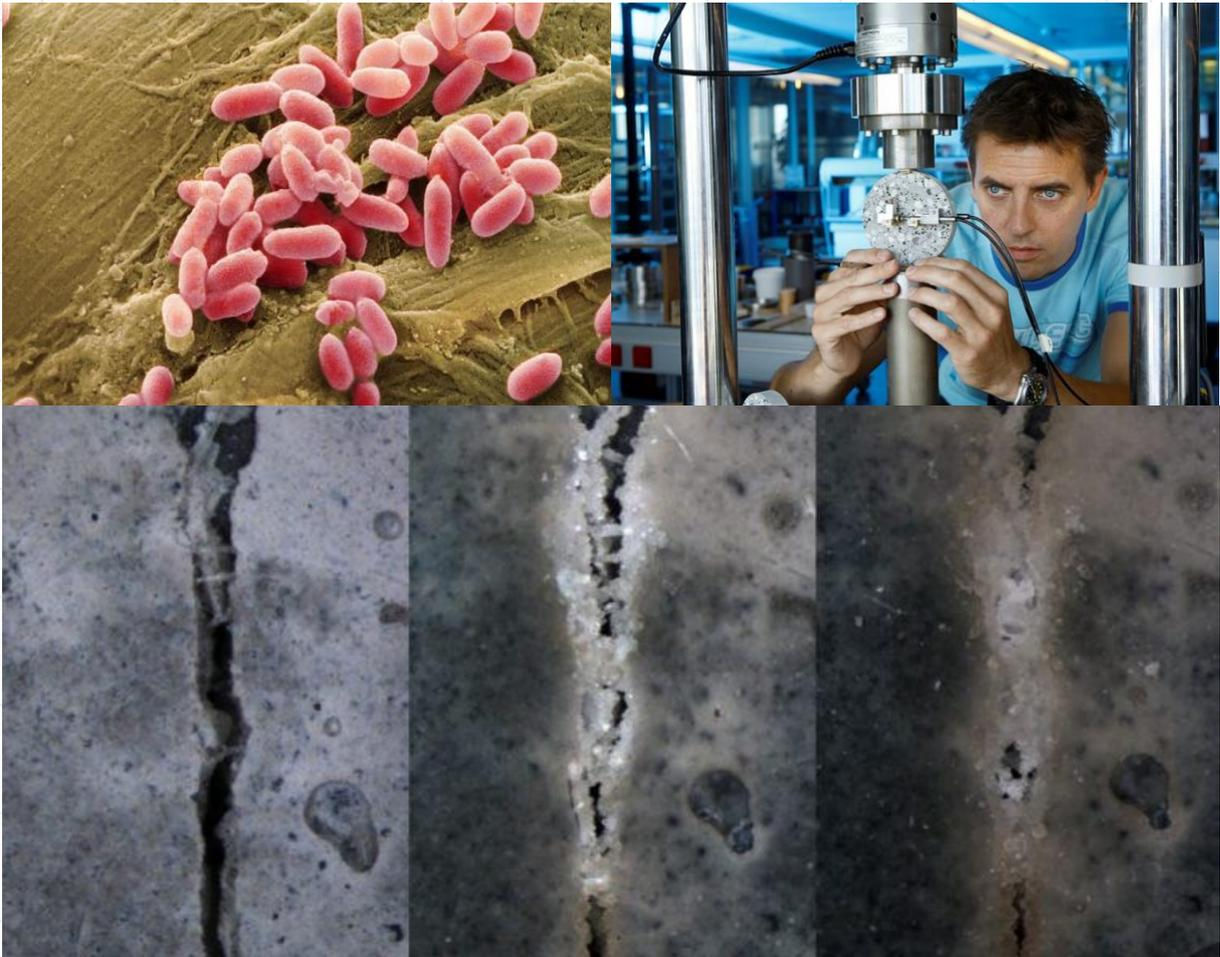
**Figura 4.** A bactéria *Bacillus pseudofirmus* acima à esquerda; a realização de teste para abertura de fissuras no concreto para avaliação da atuação da bactéria, acima a direita; abaixo da esquerda para a direita o progresso do fechamento da fissura por meio do depósito de calcário produzido pela bactéria.<sup>7</sup>
