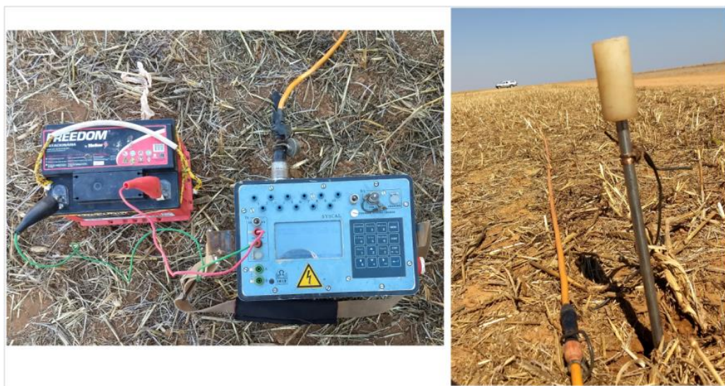
Figura 3.12. Equipamento Eletrorresistímetro SYSCAL Pro 72 e eletrodo montado pronto para iniciar o levantamento.
