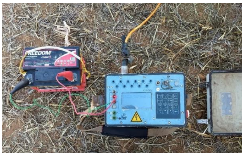
Figura 1.5. Equipamento geofísico para aquisição de dados elétricos (Eletrorresistivímetro modelo SYSCAL Pro 72).
