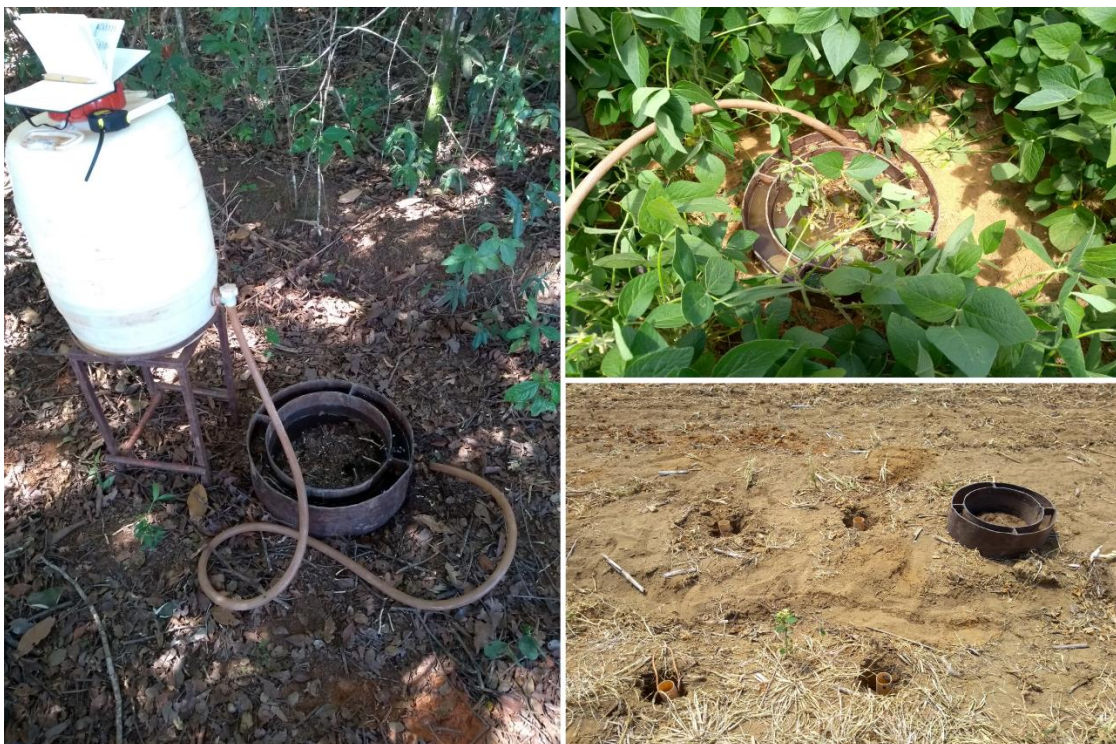
Figura 3.8. Ensaios de infiltração do tipo anéis concêntricos e open end hole , realizados nos principais usos do solo da área de recarga do Aquífero Batalha.
