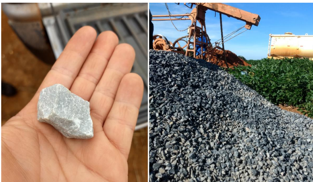
Figura 4.2. Pré-filtro comumente utilizado nas construções de poços da região. Composto por fragmentos de dolomitos de granulometria grossa a muito grossa.
