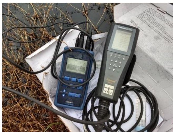
Figura 1.6. Sonda multiparâmetro YSI Professional Plus e sonda HQ 40d da Hach Instruments , utilizadas para coleta dos parâmetros (pH, temperatura, total de sólidos dissolvidos (TDS), condutividade elétrica (CE) e oxigênio dissolvido (OD)).
