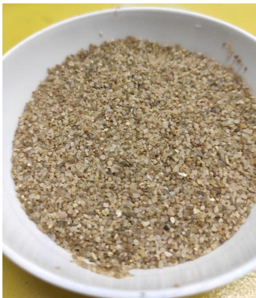
FIGURA 12. Areia de sílica utilizada nos ensaios.
