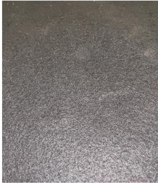
FIGURA 15. Manta sintética não tecida (MSNT) (Fabricante Mexichem), Geotêxtil Bimdim PP600.
