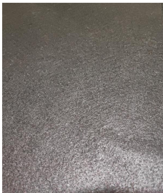
FIGURA 14. Manta sintética não tecida (MSNT) (Fabricante MacTex), Geotêxtil não-tecido em poliéster N 26.2.
