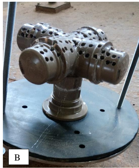
FIGURA 8. A) 1. Difusor para entrada do afluente e 2. Saída de retrolavagem, B). Difusor para entrada de água de retrolavagem e/ou saída de efluente tratado nos leitos.
