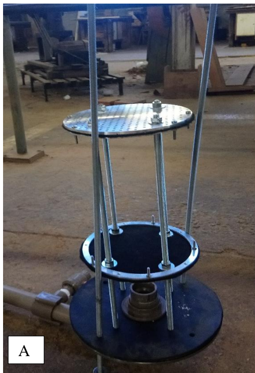
FIGURA 9. A) Barra de ferro fundido roscável interna para fixar os discos de alumínio e os anéis de alumínio para fixar as MSNT, B) Barra de ferro roscável externa para realizar a vedação com os discos de ferro fundido externo.
