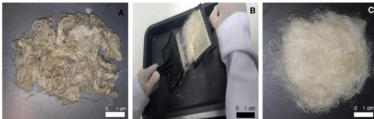
Figura 8 - A) Fibras após o tratamento químico; B) Fibras sendo desfibriladas; C) Fibras após serem desfibriladas.
