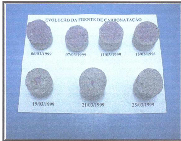
Foto 4.5 - Profundidade de carbonatação através do indicador fenolftaleína
