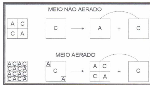
Figura 3.9 - Formação de macropilhas em meios aerado e não-aerados (GALVEZ, 1980)
