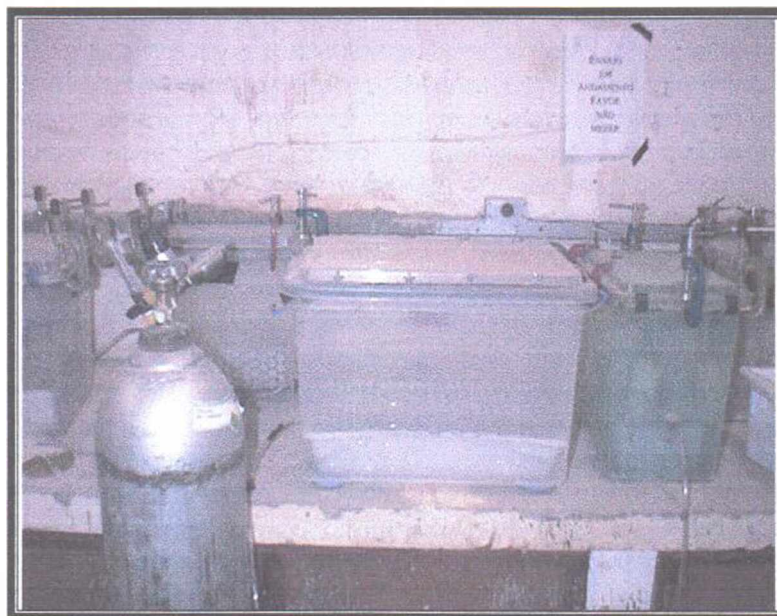
Foto 4.4 - Câmara de Carbonatação
