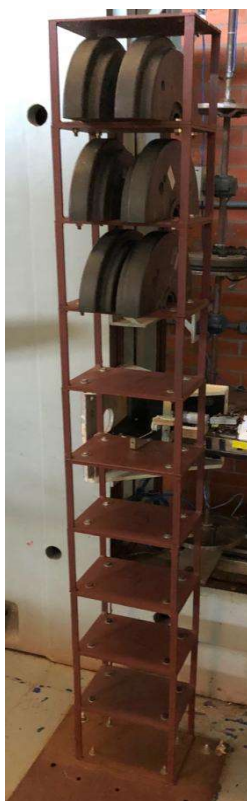
Figura 5.2 – Modelo estrutural com massas acopladas.
