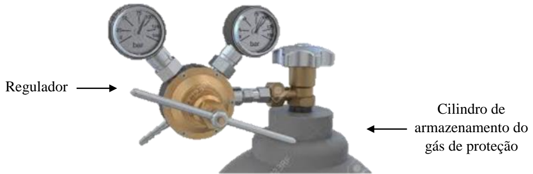
Figura 2.8: Dispositivo de blindagem com gás.
