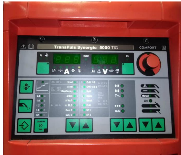
Figura 4.3: Imagem frontal do painel de controle da fonte TransPuls Synergic 5000.
