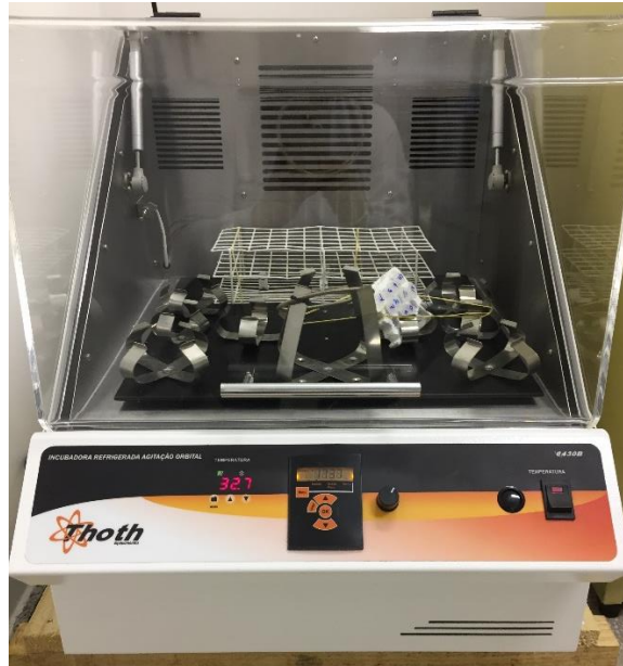
Figura 9: Agitador orbital Thoth Equipamentos, Piracicaba, SP, Brasil, onde os microtubos com corpos de prova foram incubados
