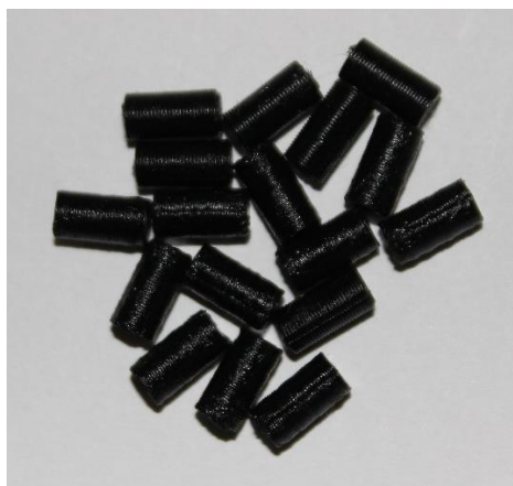
Figura 3: Cilindros de plástico impressos pela impressora 3D
