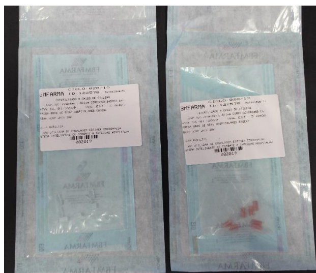
Figura 8: Cilindros de resina acrílica termopolimerizável, em grau cirúrgico, após a esterilização
