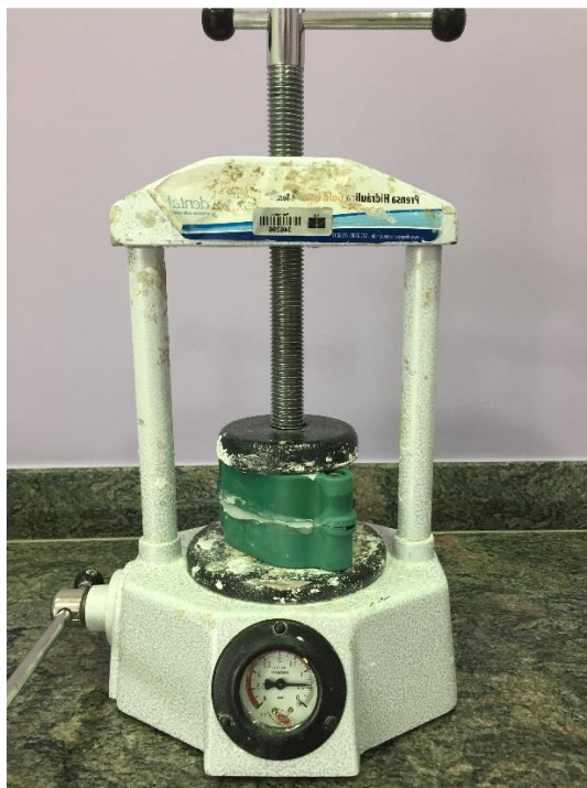
Figura 5: Mufla com resina acrílica na prensa hidráulica Gold Line VH (Essence Dental, Araraquara, São Paulo)
