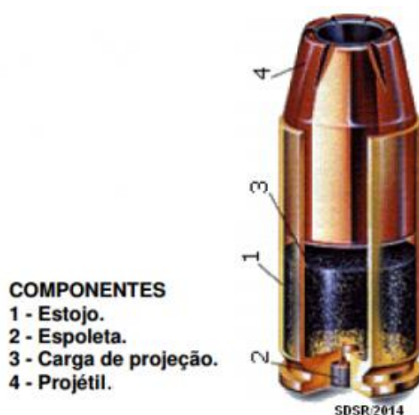
Figura 3 – Imagem dos principais componentes de um cartucho. Fonte: (Sindespe, 2014).
