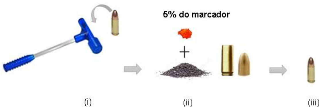
Figura 16 - Esquema de incorporação dos marcadores a munição.
