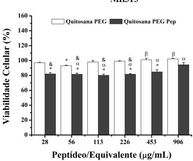
**Figura 26.** Avaliação da viabilidade de células de câncer de mama 4T1 pelo ensaio de MTT após 24 h de tratamento com nanopartícula de Quitosana PEG e Quitosana PEG Pep em diferentes concentrações. Equivalente de partículas vazias referente à quantidade de partículas presente no grupo contendo peptídeo. Diferença estatisticamente significativa (P < 0.05) em relação ao controle - 0 μg/mL (\*), 28 μg/mL (α), 56 μg/mL (β), 113 μg/mL (χ), 226 μg/mL (δ) e quitosana PEG (&).
