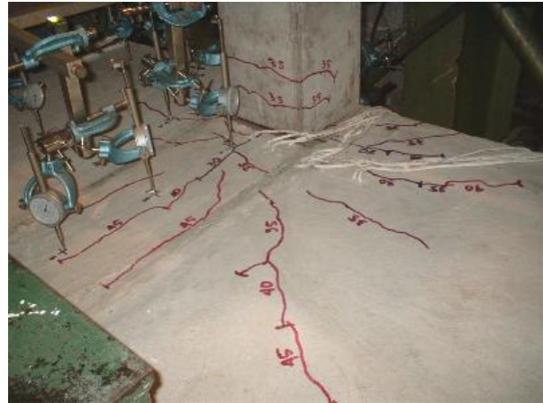
Primeiras fissuras L10
