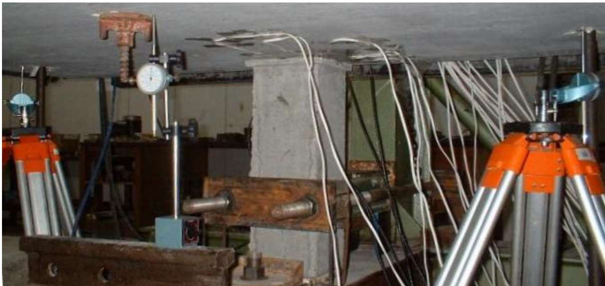
Figura 3.42 Relógios comparadores colocados sob a laje
