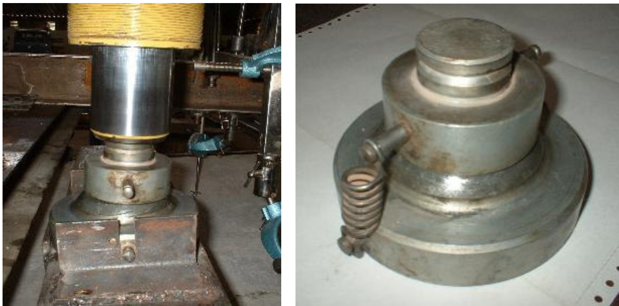
Figura 3.33 Rótula utilizada na aplicação de cargas
