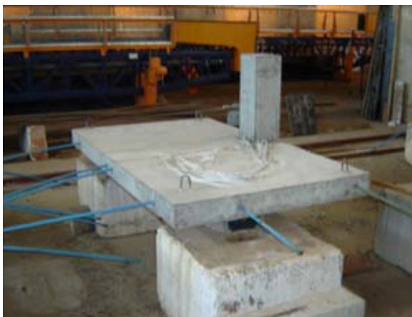
a) Posição dos ganchos para içamento
