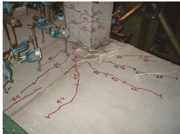
Primeiras fissuras L12
