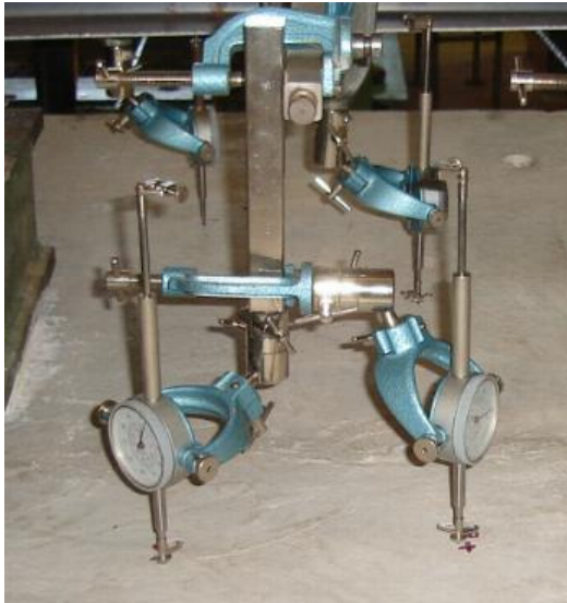
Relógios comparadores na superfície superior da laje
