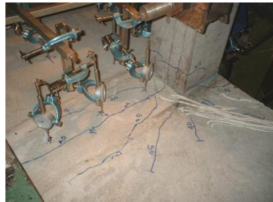
Primeiras fissuras: L8
