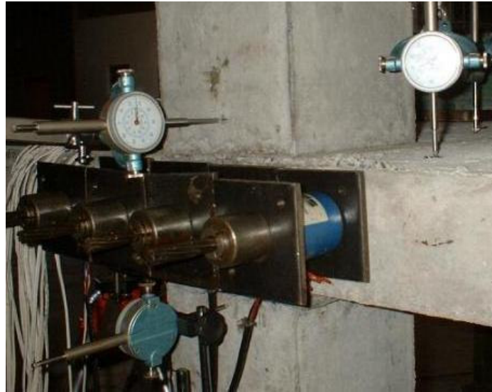
Relógios comparadores horizontais na superfície do pilar
