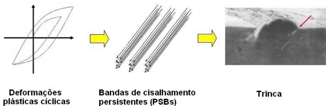
Figura 3.1: Sequência de nucleação de uma trinca por fadiga em um cristal de Cu para 60000 ciclos a 20°C. (Foto: De Ma e Laird, 1989. Copyright Pergamon Press plc.)
