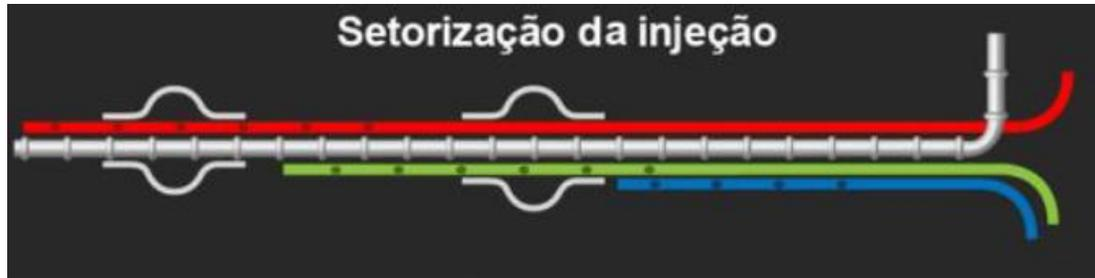
Figura 2.6 – Setorização da injeção em solo grampeado (Pitta *et al.*, 2013)
