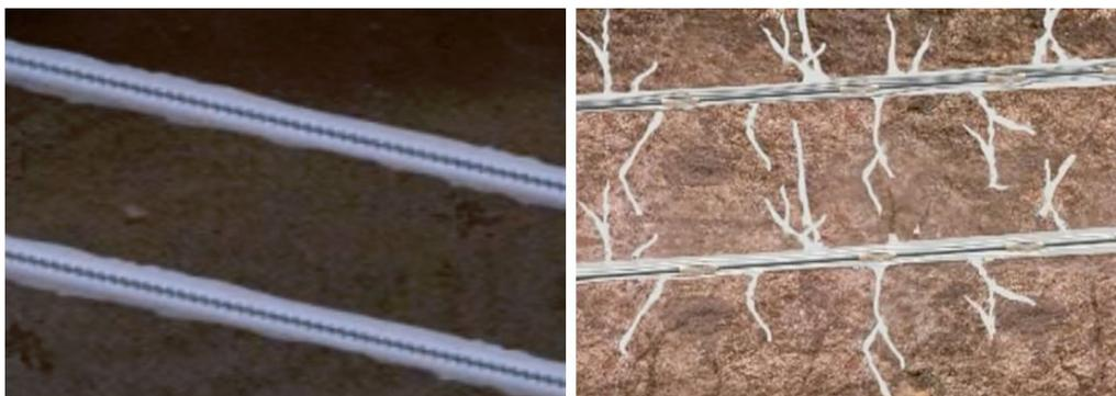
Figura 1.1 – Solo grampeado sem injeção multifásica à esquerda e solo grampeado com injeção multifásica à direita (Pitta *et al.*, 2017)
