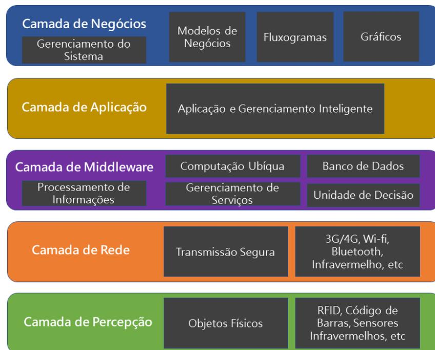
Figura 2.2: Arquitetura em camadas da IoT. Adaptado de [2].
