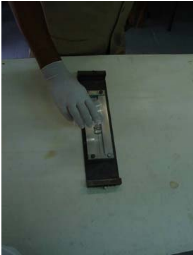
Figura 3.11. Preenchimento do molde com resina epóxi.
