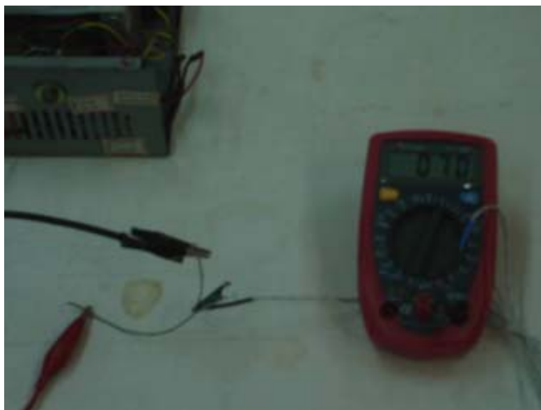
Figura 3.15 - Aparato para medir a temperatura do fio de SMA.
