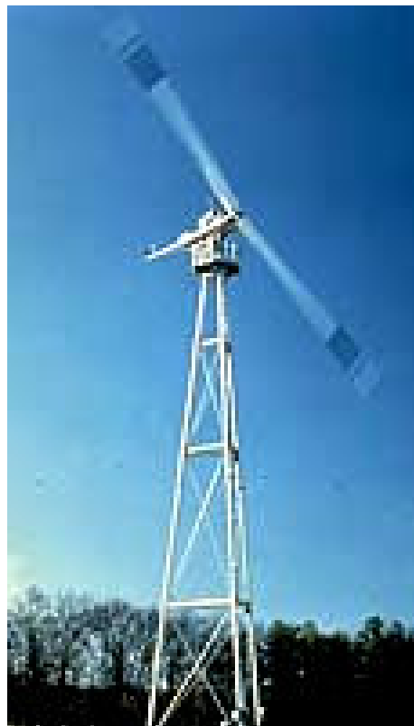
Figura 2.12 - Pás de moinho com material compósito (MATTHEUS & RAWLINGS, 1994).
