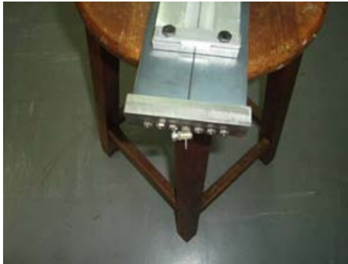
Figura 3.8. Detalhe do parafuso trava utilizado para o correto tensionamento dos fios.
