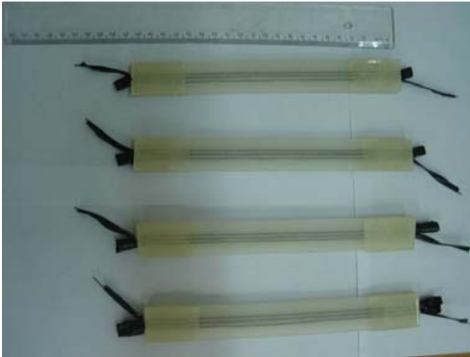
Figura 3.14. Cp's prontos para o ensaio na fase Austenita.
