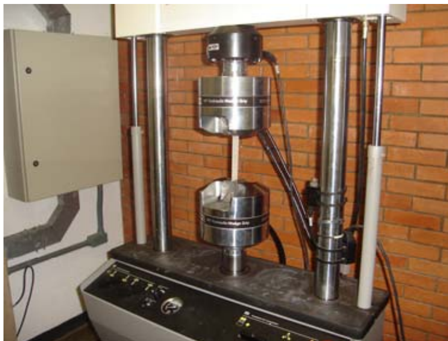
Figura 3.17. Máquina hidráulica de tração MTS – 810.
