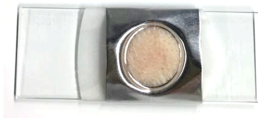
Figura 4.1.2 Pele de porco disposta sobre papel de filtro embebido com tampão HEPES pH 7,4. A área da pele foi delimitada por fita adesiva laminada com círculo de 15 mm de diâmetro.
