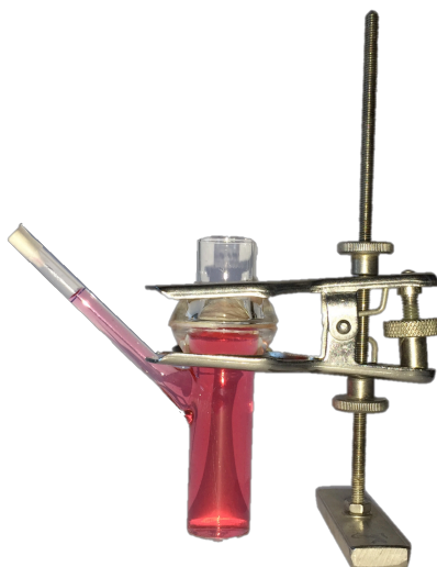
Figura 4.2.5 Célula de Franz montada para estudo de permeação cutânea ex vivo .
