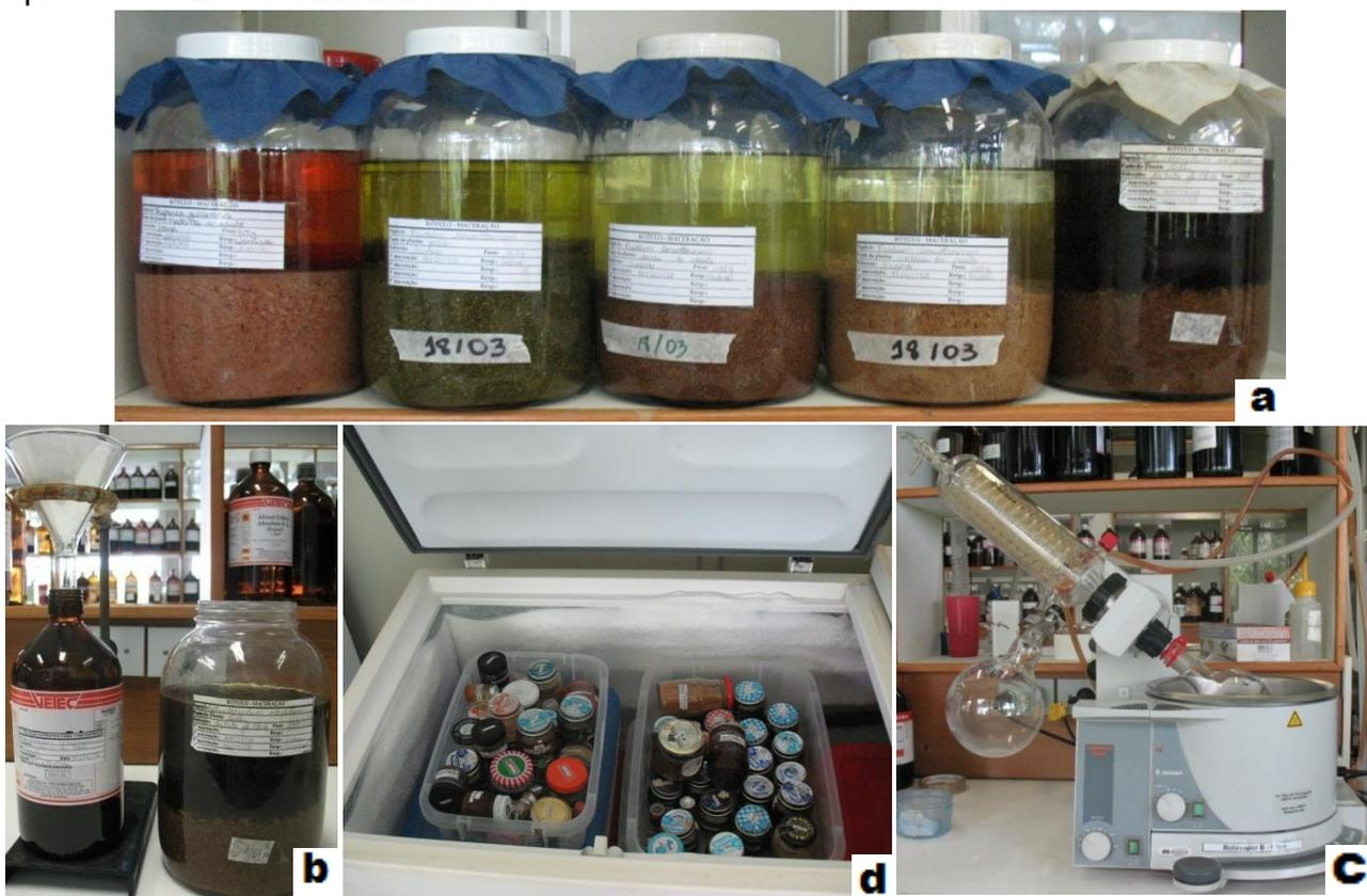
**Figura 20** – (a) Processo de extração por maceração, (b) Filtração para a obtenção da solução da solução extrativa, (c) Concentração em rota-evaporador, (d) Armazenamento do extrato bruto a -20 °C.
