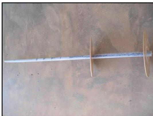
Figura 4.6 – Fotografia do medidor de espuma.
