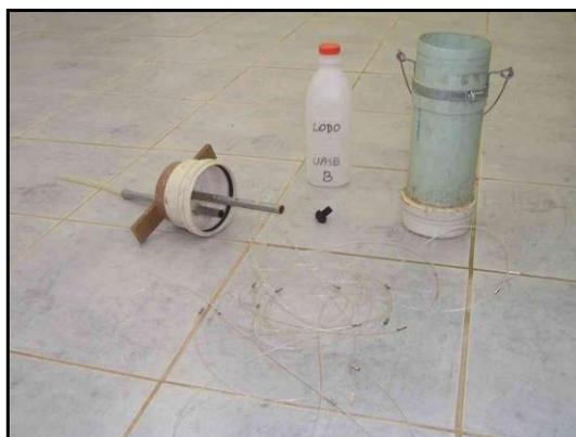
Figura 4.4 – Fotografia do amostrador de manta de lodos.
