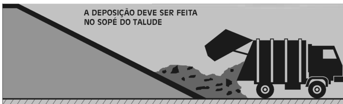
Figura 1.3 – Deposição dos resíduos sólidos domiciliares na aterro. Fonte: Sarsby (1995).
