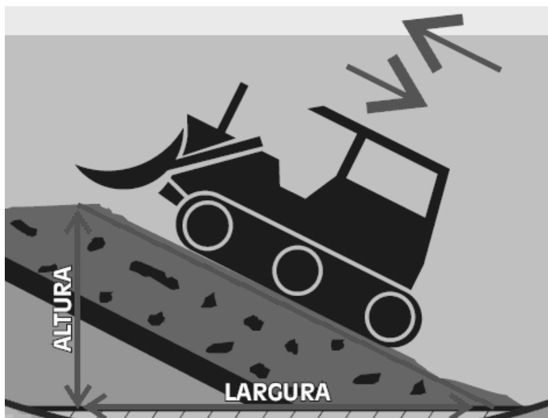
Figura 1.4 – Compactação e sentido da disposição dos resíduos sólidos domiciliares Fonte: Sarsby (1995).
