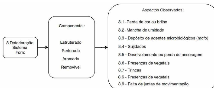
Figura 13 – Deterioração no Sistemas de Forro
