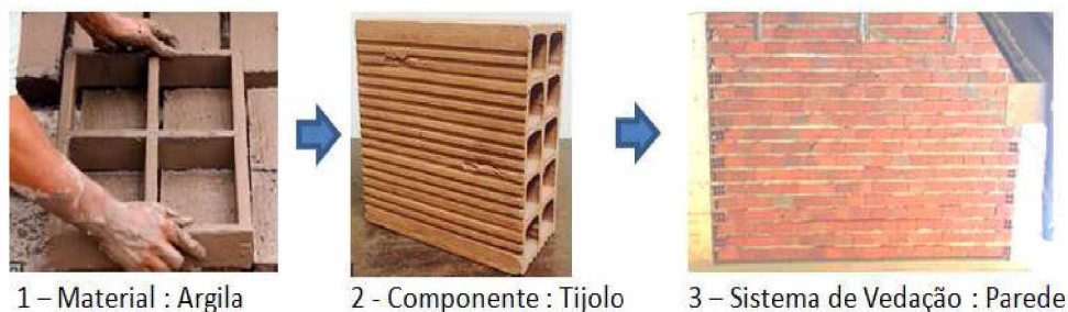
Figura 3 – Conceito de Sistema de acordo com a ABNT NBR 15575-1:2013 Fonte: Arquivo pessoal
