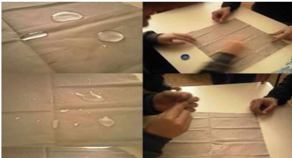
Figura 8: Tecido nanoestruturado, que repele água, não mancha e impede o odor.
