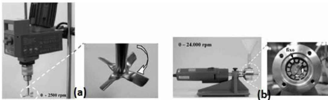
Figura 8 – Equipamentos utilizados na dispersão da sílica ativa: (a) misturador rotacional com hélice naval IKA, modelo Labortechnik RW20, com potência do motor 70/35 W e rotação máxima 2.500 rpm; (b) dispersor de elevada energia de cisalhamento IKA modelo Labortechnik T25 basic com potência 500/300 W e rotação máxima 24.000 rpm (ROMANO et al. , 2008).
