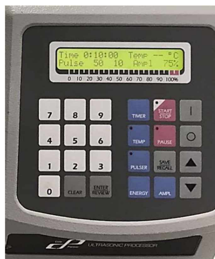
Figura 28 – Parâmetros de entrada para o processo de ultrasonicação.
