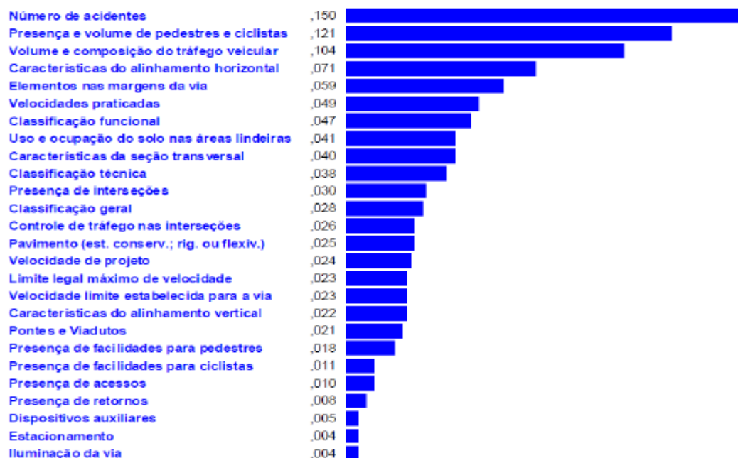
Figura 3.1 – Lista hierárquica dos fatores para definição da velocidade limite em rodovias brasileiras
