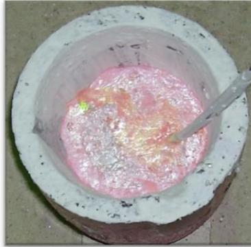
Figura 3-2 - Cadinho, revestido por uma fina camada de alumina.
