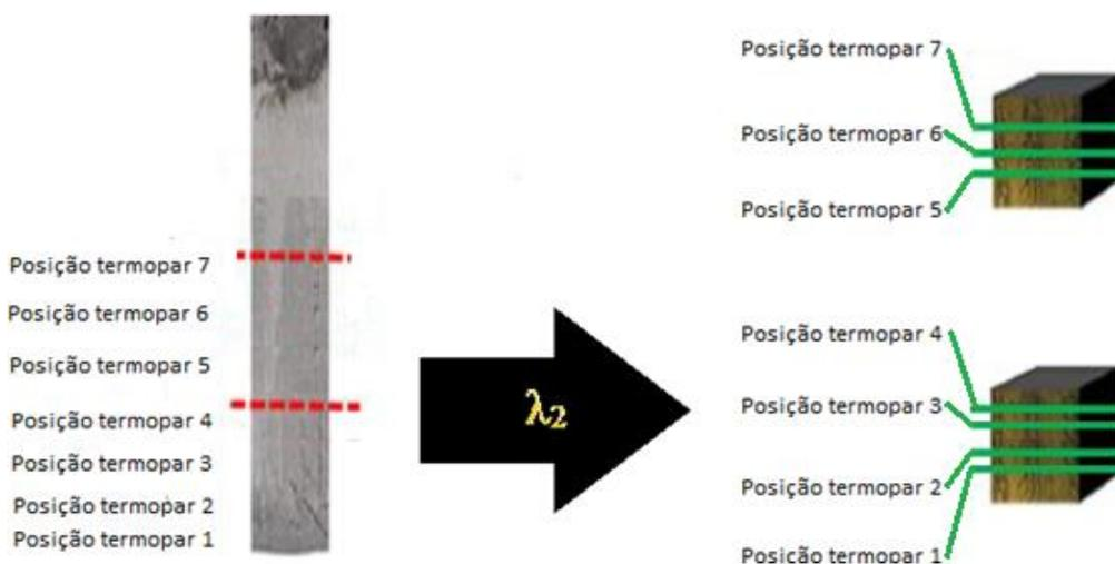
Figura 3-11 - Representação esquemática dos cortes feitos para a quantificação dos espaçamentos secundários.(Dantas 2014, adaptado)
