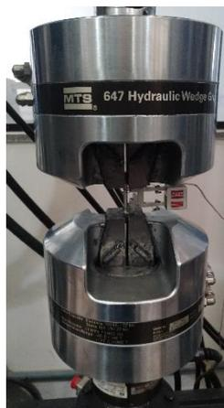
Figura 3-16 - Realização do ensaio de tração, com auxílio de extensômetro.
