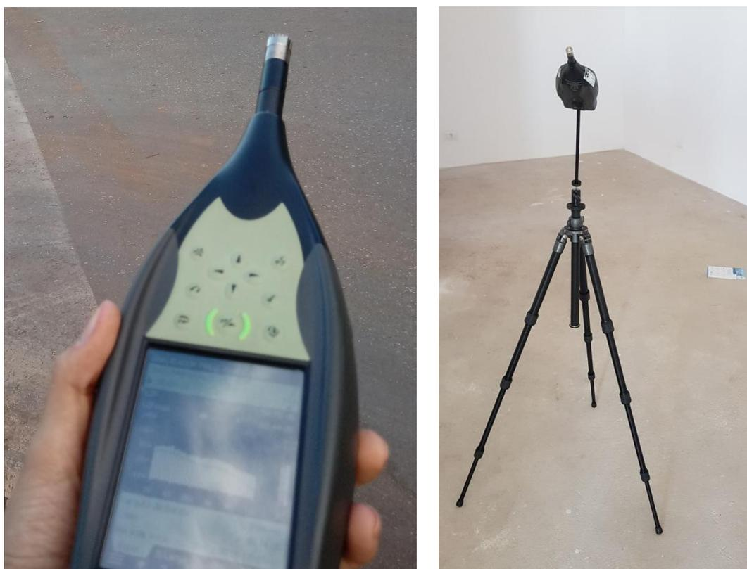
Figura 21 – Sonômetro fabricante Bruel & Kjaer, modelo 2250 e o tripé fabricante Bruel & Kjaer utilizado nas medições
