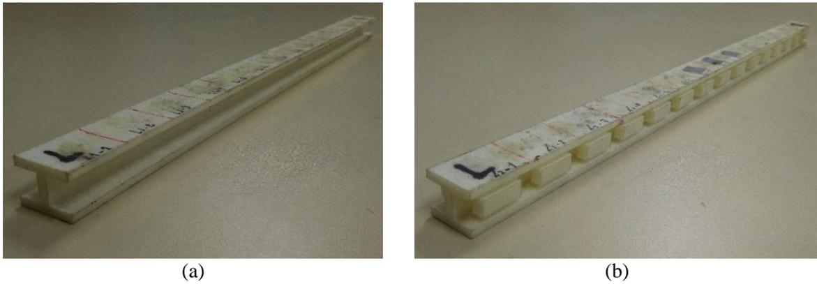
Figura 21. Vigas sintetizadas: (a) simples e (b) com ressonadores.
