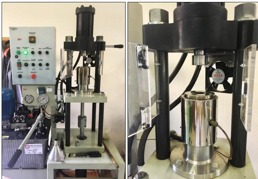
Figura 3.7. Briquetadeira utilizada. À direita o detalhe do cilindro compactador.
