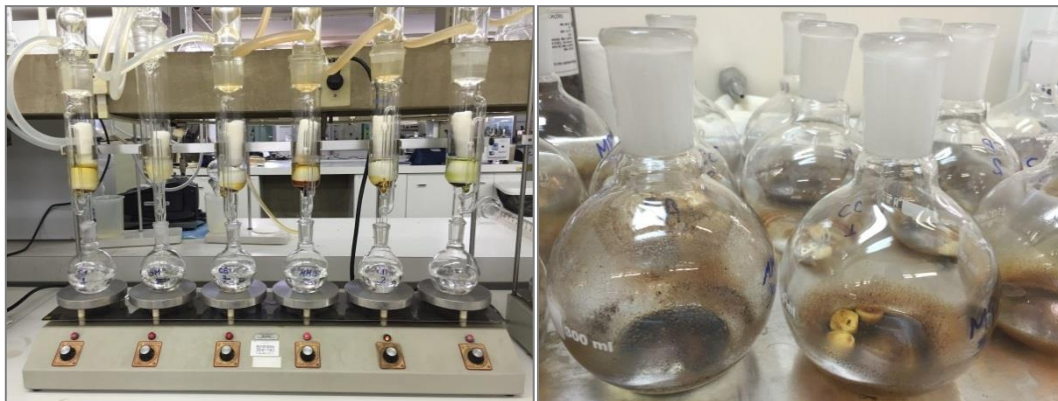
Figura 1.8. Retirada dos extrativos dos resíduos. A – extrator; B- balões com extrativos.
