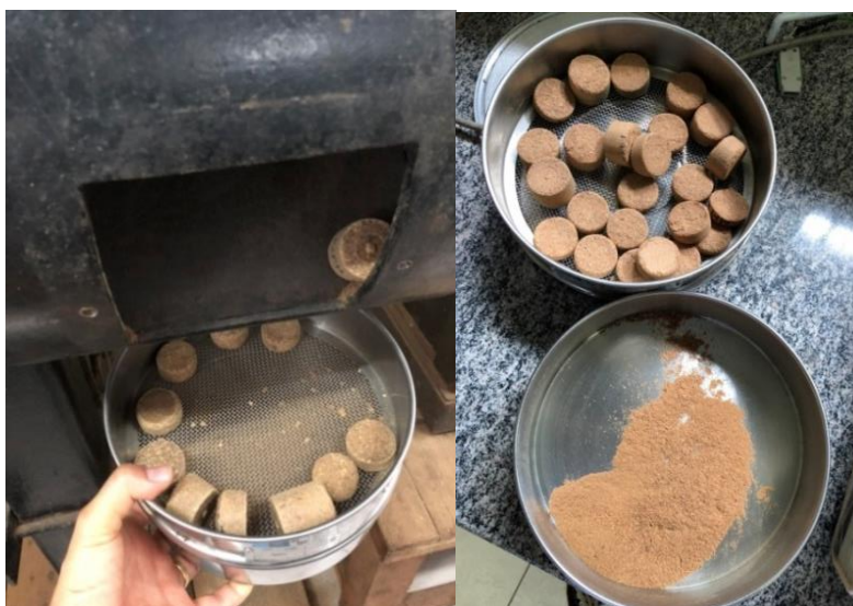
Figura 3.10. Briquetes sendo retirados do tambor após o rotacionamento e peneirados para obtenção dos finos (à direita).
