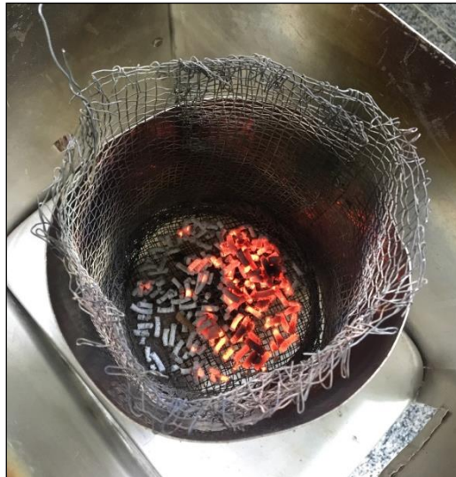
Figura 2.11. Detalhe do ensaio de combustão de pellets demonstrando a queima da biomassa na grelha e no sistema combustor. Foto: autora.
