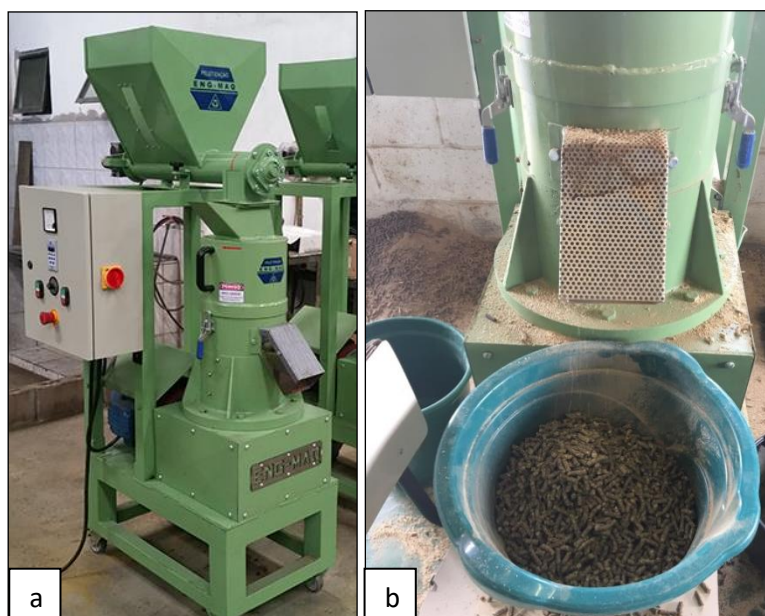
Figura 2.7. Peletizadora utilizada. À esquerda (a) o equipamento comercializado pelo fabricante (Foto: Eng-Maq). À direita (b) a máquina funcionando durante a execução deste trabalho. Foto: autora.
