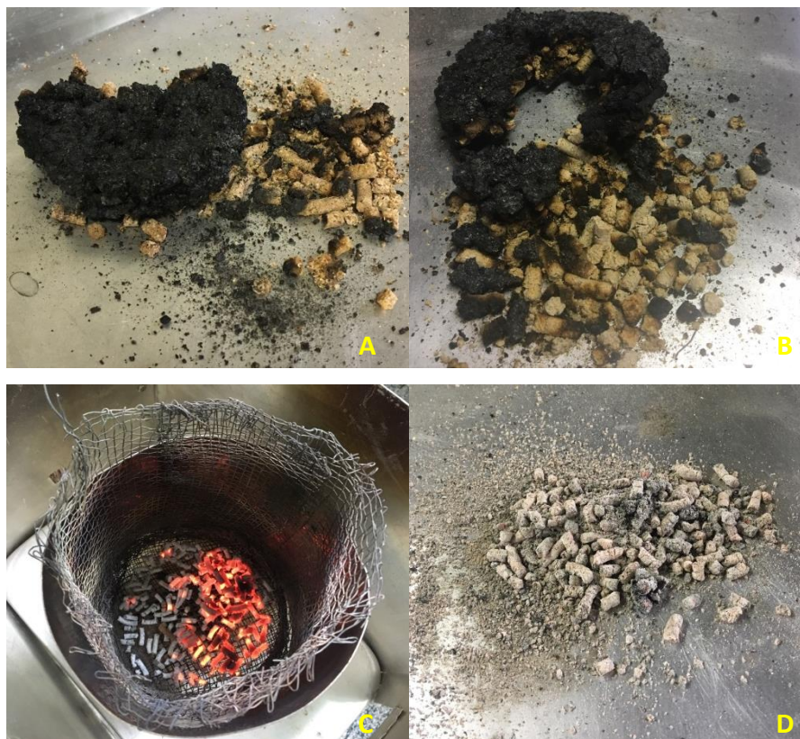
Figura 2.18. Resíduos do processo de combustão dos pellets de sorgo (A), de quirela de milho (B), de sabugo (C) e de quirela+palha (D).
