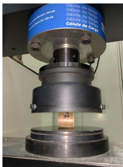
Figura 3.9. Ensaio de resistência à compressão diametral.
