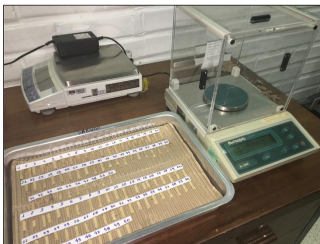
Figura 2.9. Ensaio de densidade aparente dos pellets. Foto: autora.
