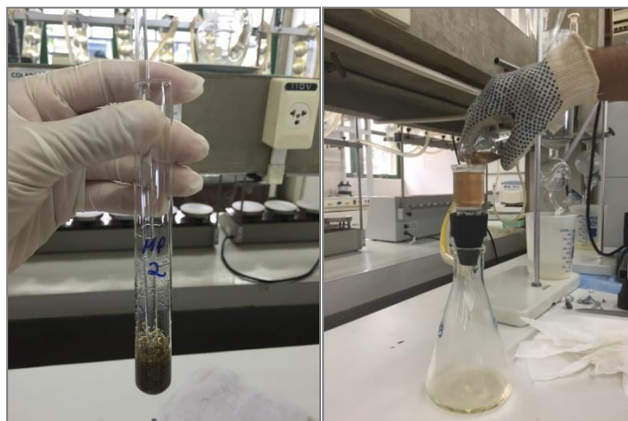
Figura 1.9. Processo de isolamento da lignina ácida solúvel e insolúvel. A – tubos de ensaio para banho-maria; B – cadinhos filtrantes.
