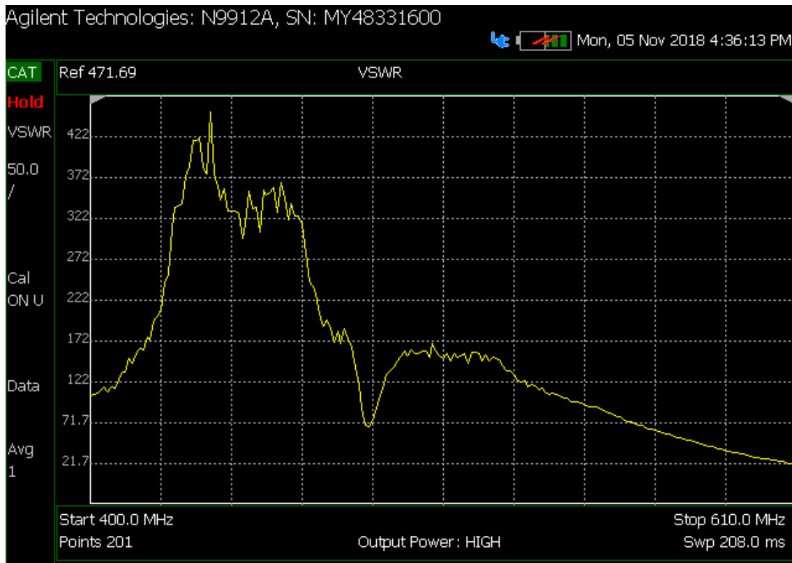
Figura 7.15: Curva inicial do VSWR sem nenhum tipo de ajuste (5 pontos sigma).
