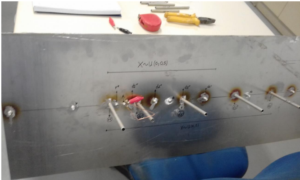
Figura 7.14: Antena com 5 pontos sigma ( X \sim U(0,1) ).
