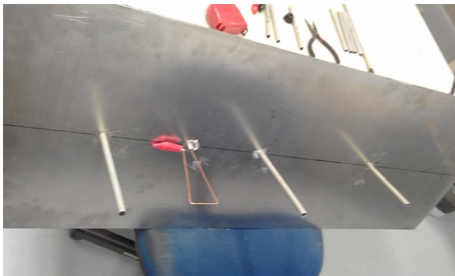
Figura 7.5: Posição e forma do alimentador no Teste 5.
