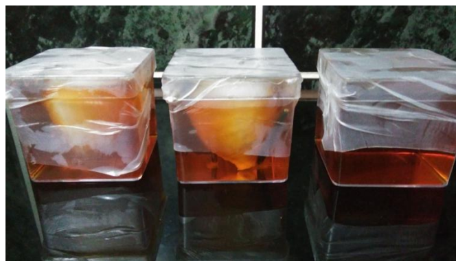
Figura 19 - Arranjo dos simuladores antropomórfico de próstata em 3D com Fricke gel dosimétrico.
