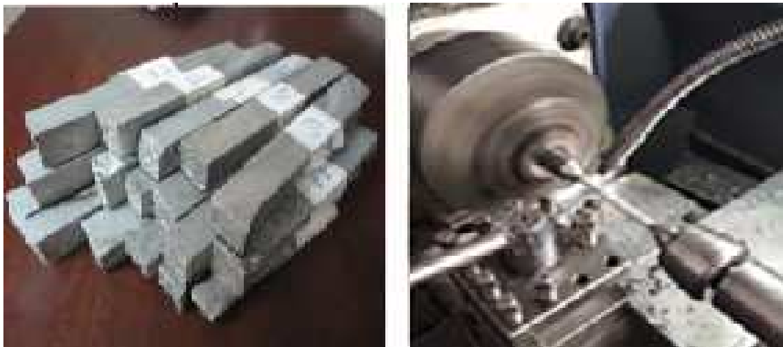
Figura 3.12 – Corpos de provas sendo pré-usinados.
