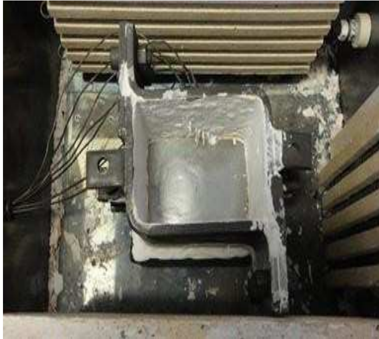
Figura 3.4 - Foto do posicionamento dos termopares no interior da lingoteira.
