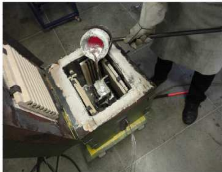
Figura 3.5 - Vertendo o metal líquido dentro da lingoteira.
