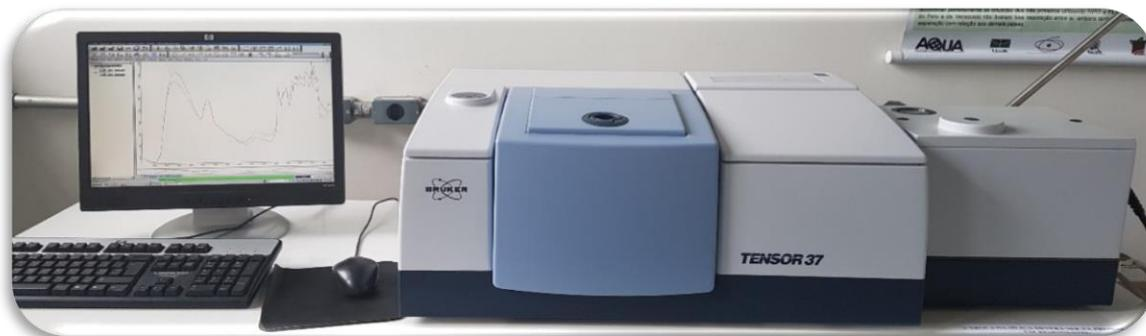
Figura 5.2. Espectrofotômetro de infravermelho com transformada de Fourier, marca Bruker, modelo Tensor 37.
