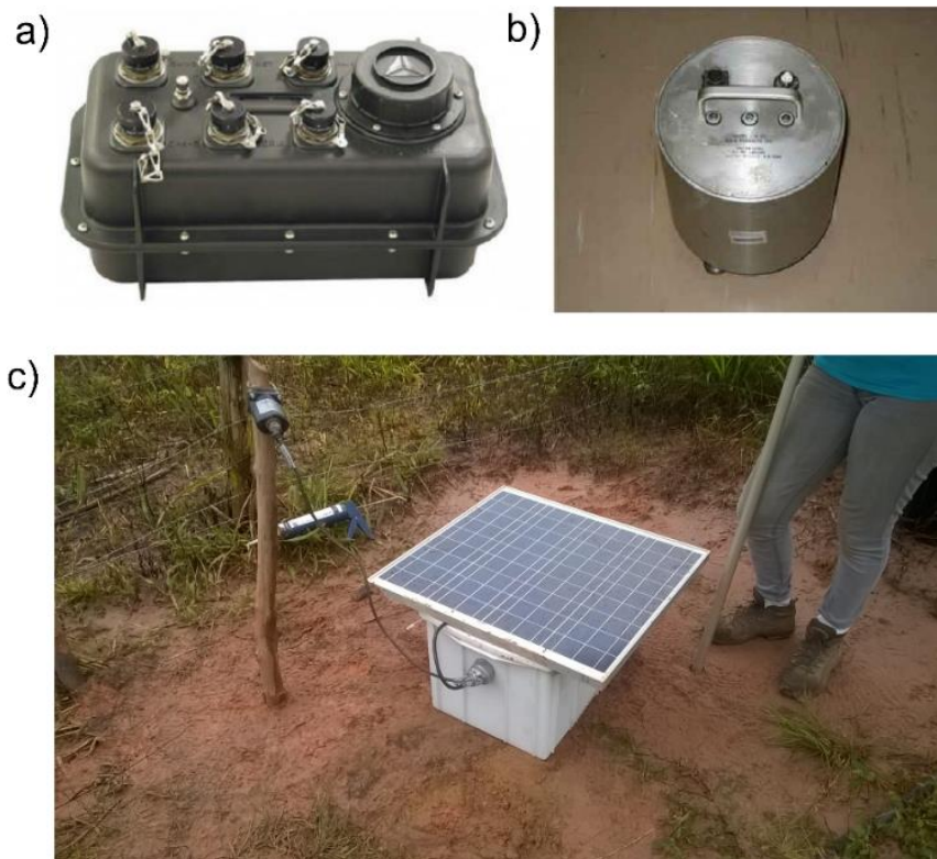
Figura 14: Em a) registrador marca RefTek modelo DAS130 e em b) sensor Sercel L-4A-3D, que compunham as estações de período curto da rede sismográfica N-S da Bacia do Parnaíba. c) Fotografia de estação instalada em campo.
