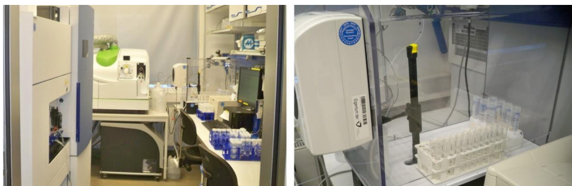
Fig. 11: Espectrômetro de massa do Geochemistry Lab da JUB: a) PerkinElmer DRC-e quadrupole inductively coupled plasma mass spectrometer (ICP-MS) ; b) amostras diluídas prontas para leitura no ICP-MS.
