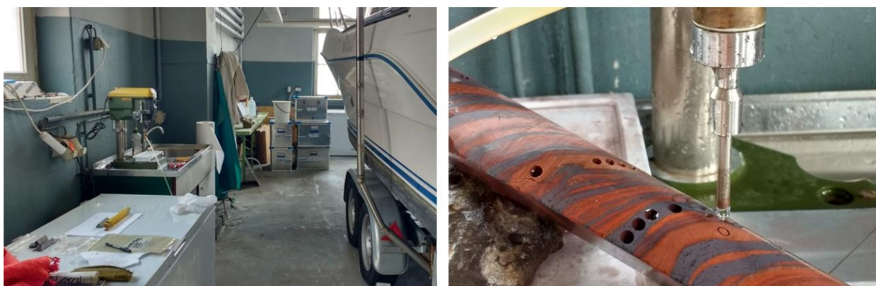
Fig. 5: Preparação das amostras de bandas individuais de BIF com o microdrill .
