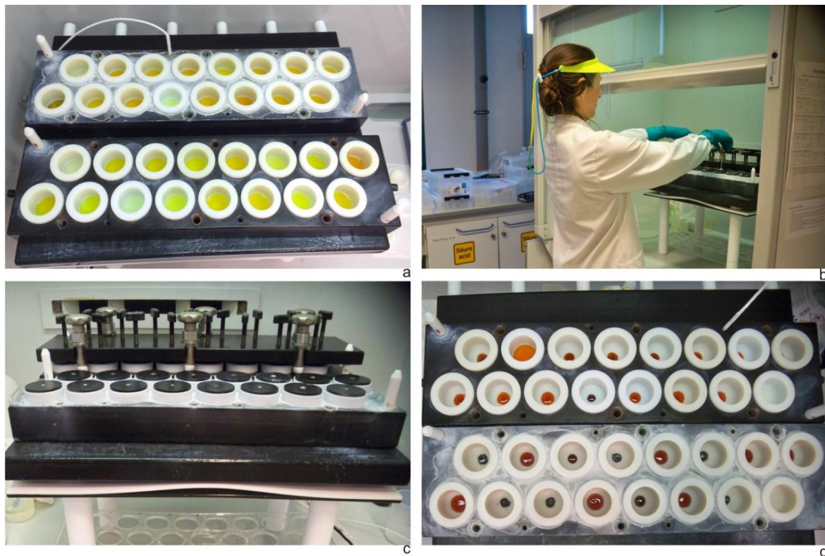
Fig. 10: Processo de digestão em solução multi-ácida (HF+HNO 3 +HCl) sob pressão (Pico-Trace): a) disposição das amostras diluídas nos blocos do PicoTrace; b-c) estabelecimento das condições para digestão multi-ácida em ambiente pressurizado sobre chapa aquecida até 225°C; d) evaporação dos ácidos sobre chapa aquecida até 90°C, visando atingir a secagem incipiente das amostras contendo os REY em solução, a ser diluída para subsequente leitura no ICP-MS.
