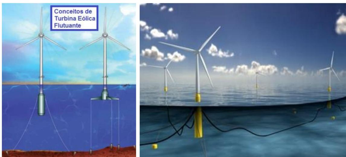
Figura 1. 3 – Esquema de fixação dos aerogeradores *offshores* no fundo do mar (adaptado de Stewart *et al.*, 2011).
