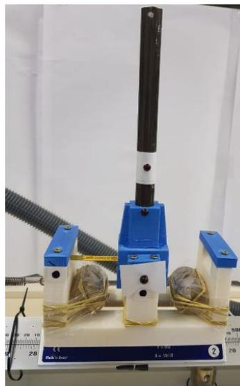
Figura 5. 54 – Bancada montada para experimentação do sistema com 2GdL e AMS-PI – CA2.
