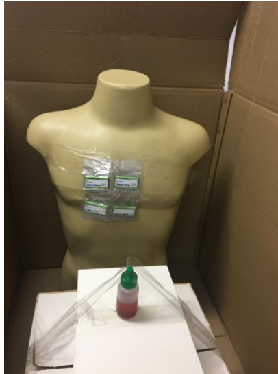
Figura 15 - Visão frontal da fonte de ^{137}\text{Cs} e do fantoma sem o avental.
