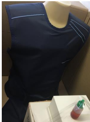
Figura 16 - Visão frontal da fonte de ^{137}\text{Cs} e do fantoma com o avental.
