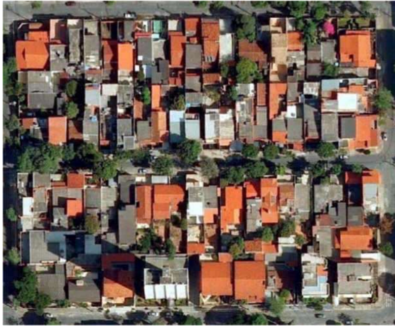
Figura 36: Quadras do bairro Nova Floresta, com lotes de aproximadamente 8,00 metros de largura. FONTE: Google Earth Pro , 2009.
