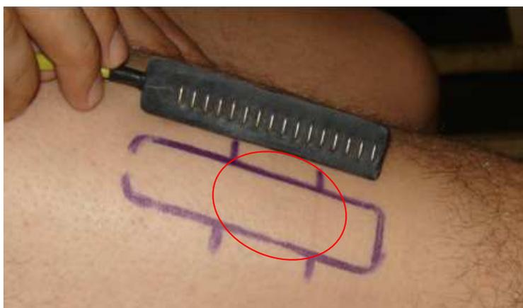
Na área demarcada era colocado um arranjo linear flexível de oito eletrodos (LISiN – Ot Bioelettronica). Esse arranjo possui as mesmas dimensões que o eletrodo rígido, porém é preso à pele por uma espuma bi-adesiva e contém orifícios para a inserção de gel condutor, o que o torna menos sensível ao artefato de movimento (figura 21). Trinta micro-litros de gel foram depositados em cada fenda por uma micropipeta (HTL).
