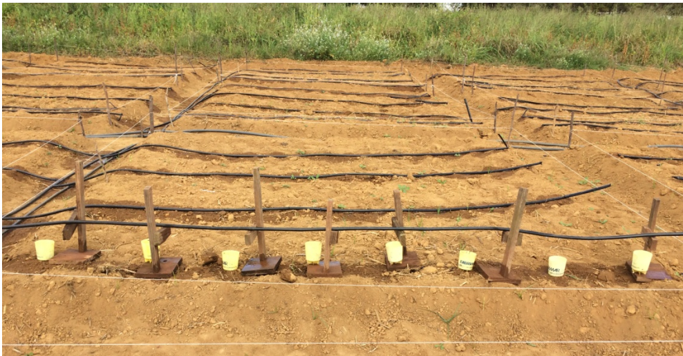
FIGURA 4. Determinação da vazão dos gotejadores no sistema de irrigação por gotejamento.
