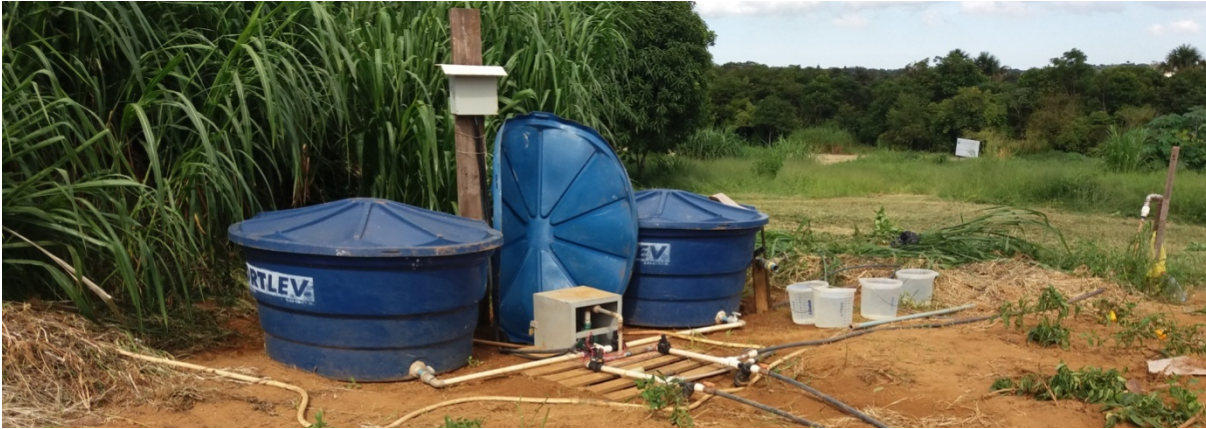
FIGURA 3. Equipamentos utilizados para a aplicação de águas e efluente tratado para irrigação.
