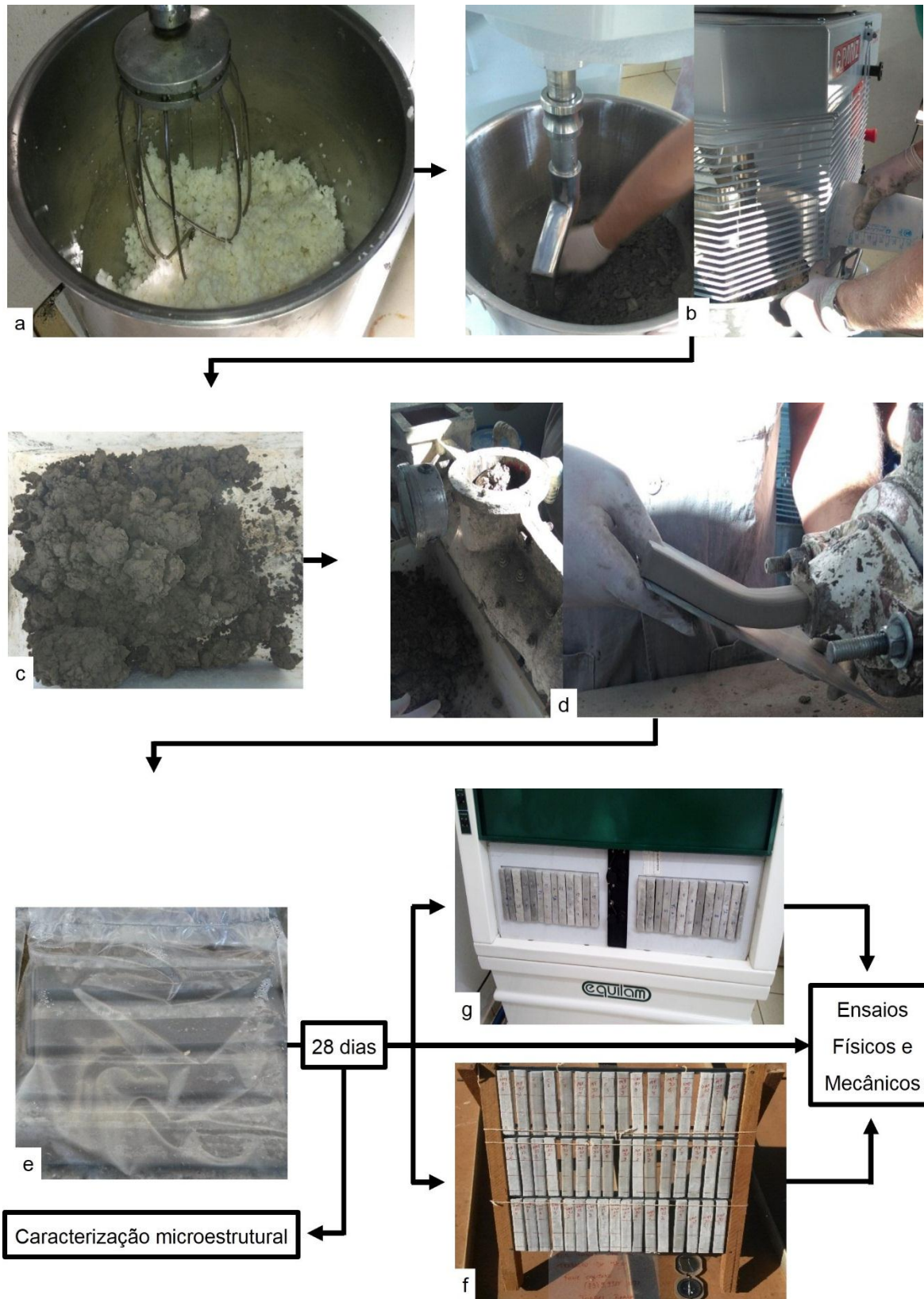
Figura 3.1. Fluxograma com as etapas de: I) produção (a) desagregação das fibras de polpa celulósica (UMF e MF), (b) mistura dos componentes do compósito em batedeira planetária, (c) mistura pronta para ser extrudada, (d) processo de extrusão
