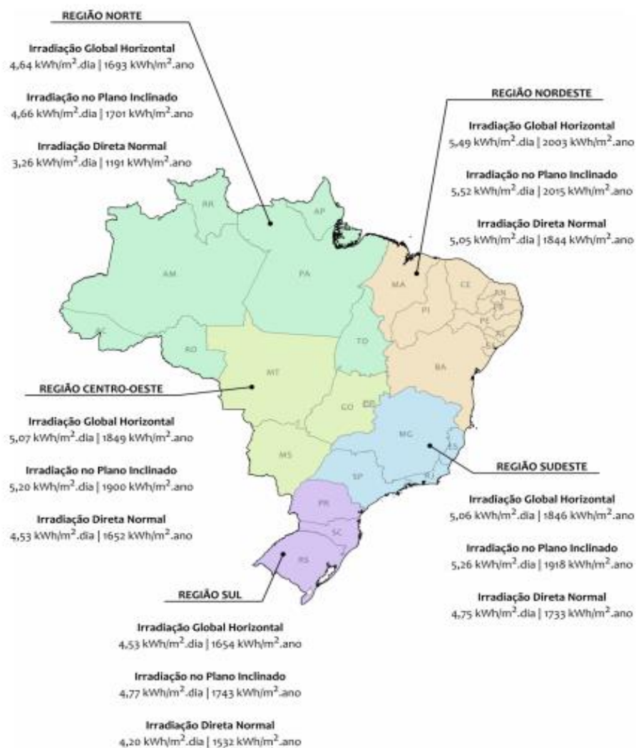
Figura 2.9 - Síntese dos níveis de irradiação por região Fonte: Atlas Brasileiro de Energia Solar – 2ª Edição (2017).
