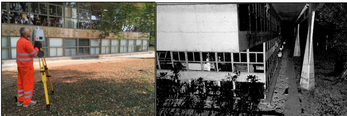
Figura 6.4 -a) técnico da Universidade de Ferrara, Guido Galvani, realizando o escaneamento; b) nuvem de pontos gerada a partir do levantamento realizado pela equipe técnica da Universidade de Ferrara. Fonte: EQUIPE CONSERVA FAU, 2016.
